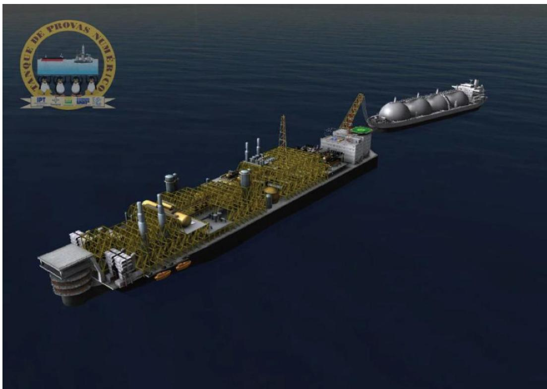
Slika 5-6. Tandemsко povezivanje sa sustavom opterećenja pramca (Teles et al., 2010)
