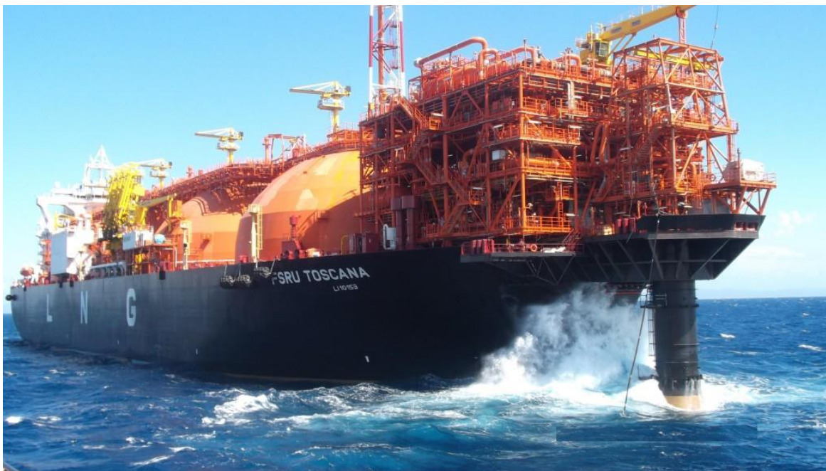
Slika 3-2. Plutajući LNG terminal u Toskani ( www.exmar.be , 2014)
