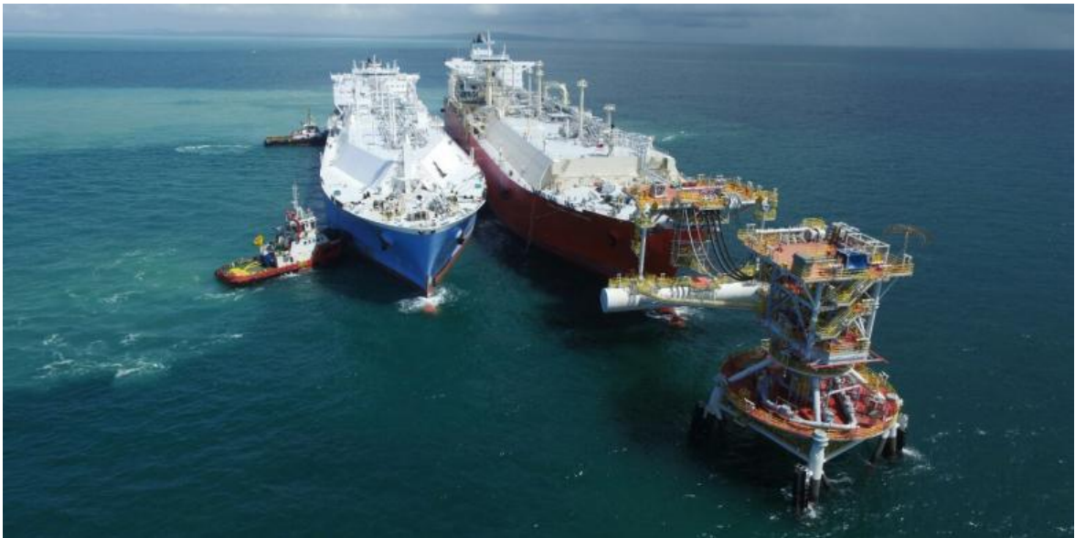
Slika 2-1. Sidrenje FSRU na bovi (www.lngworldnews.com, 2014)
