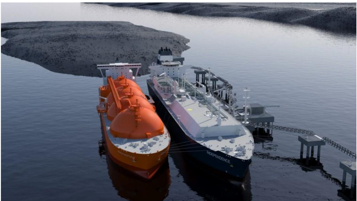
Slika 2-2. Sidrenje FSRU na gatuu sustavu brod-brod (www.lngworldnews.com, 2014)
