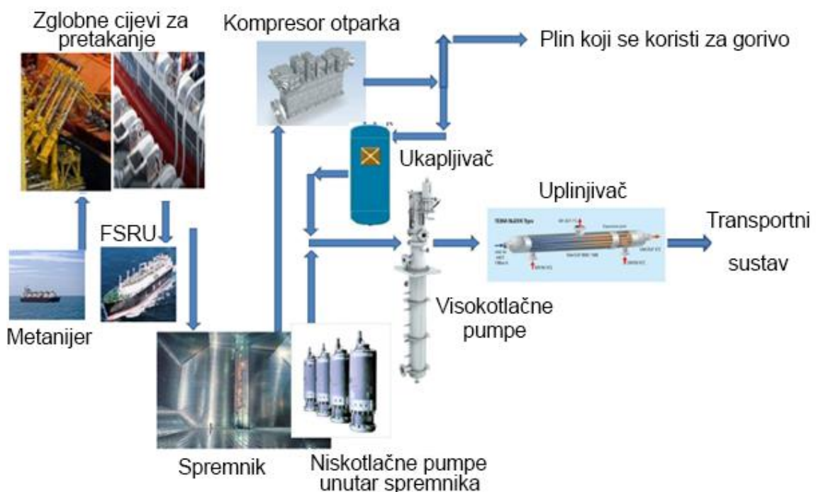
Slika 2-6. Tok prirodnog plina na terminalu za uplinjavanje (Songhurst, 2017)
