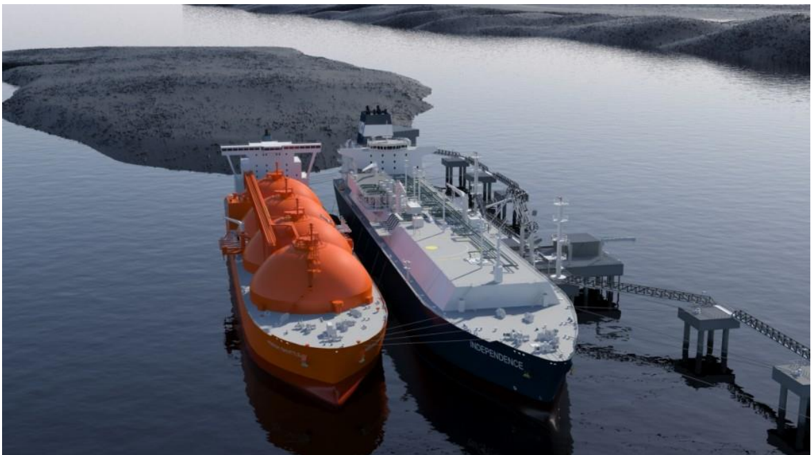
Slika 2-2. Sidrenje FSRU na gatuu sustavu brod-brod (www.lngworldnews.com, 2014)
