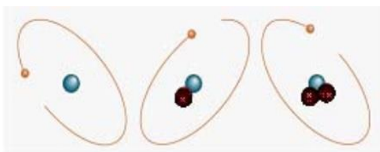
Slika 3.8. - Izotopi vodika: ^1\text{H} (1 proton u jezgri, lijevo), ^2\text{H} (1 proton i 1 neutron u jezgri, u sredini), ^3\text{H} (1 proton i 2 neutrona u jezgri, desno) (Krajcar Bronić, 2007)
