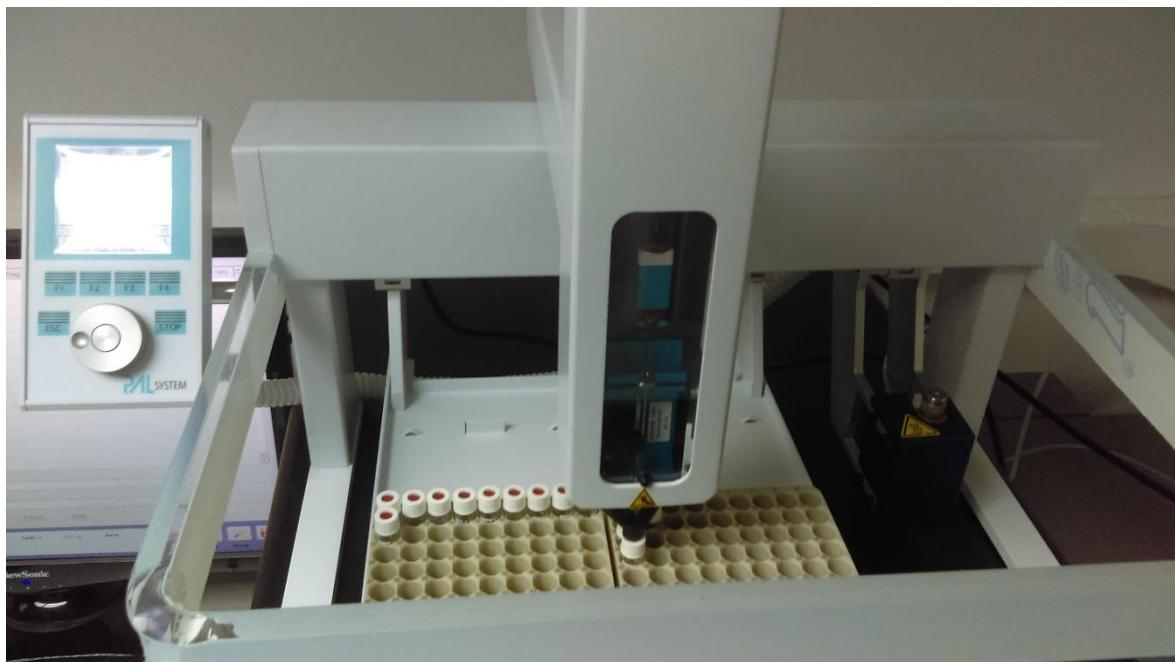
Slika 3.9. – Uređaj za mjerjenje stabilnih izotopa vode
