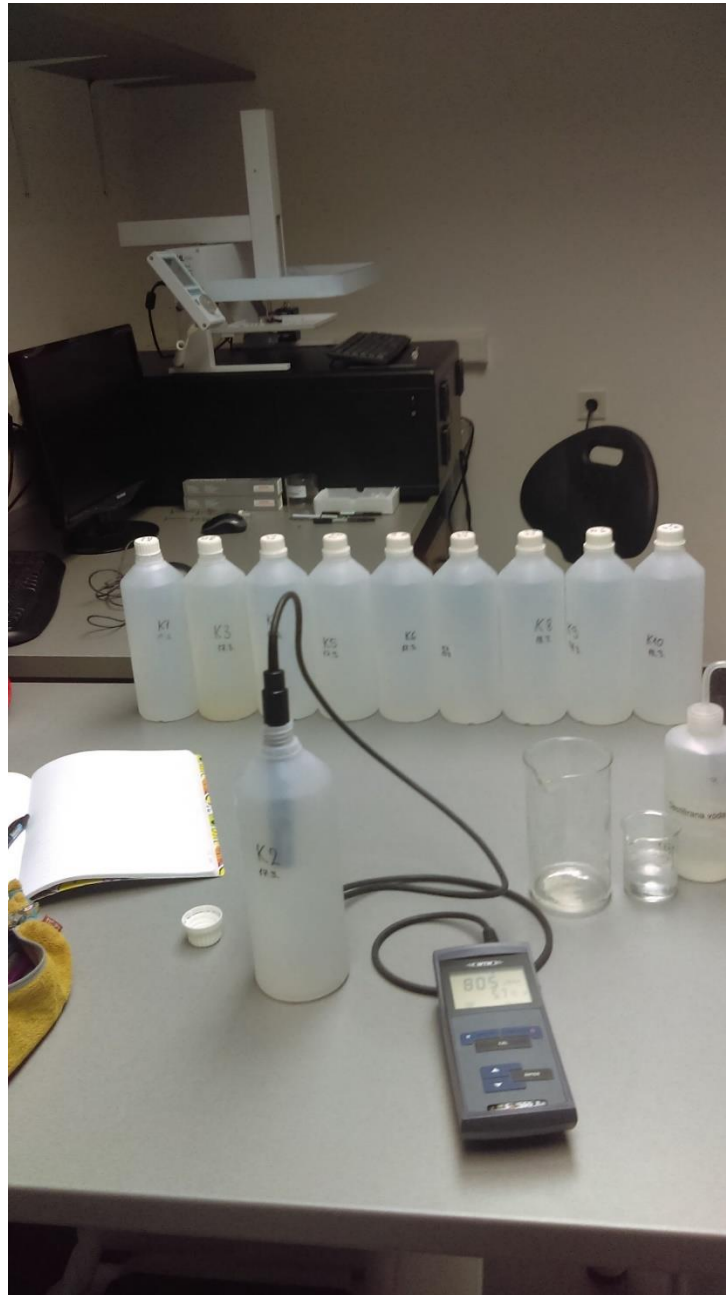
Slika 3.5. - Mjerenje električne vodljivosti u laboratoriju
