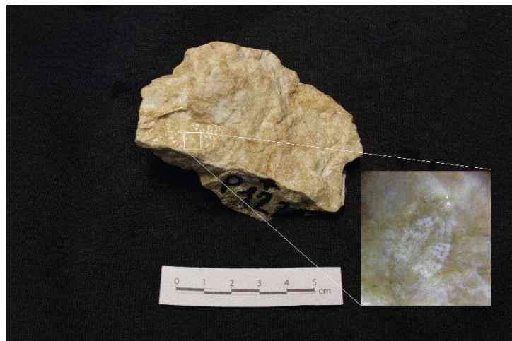
Slika 5-20. Foraminiferski vapnenac s alveolinidom. Točka P<sub>122</sub>, vrh Plas.
