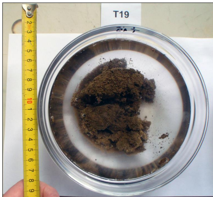
Slika 6-38. Degradacija nedisperzivnog uzorka oznake T19 nakon sušenja i potapljanja u vodi u trajanju od pola sata. Uzorak je raspucan, odlomci otpadaju s bočnih stranica, a primarni oblik uzorka je teško prepoznatljiv, što je prema slici 5-12 klasificirano kao klasa 4.
