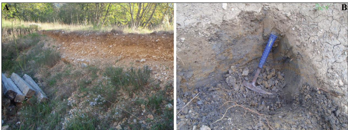
Slika 7-1. Dva tipa pokrivača koja se razlikuje prema vrsti matične stijene: A – šljunak nastao trošenjem karbonata; B – prahovita glina nastala trošenjem fliša.
