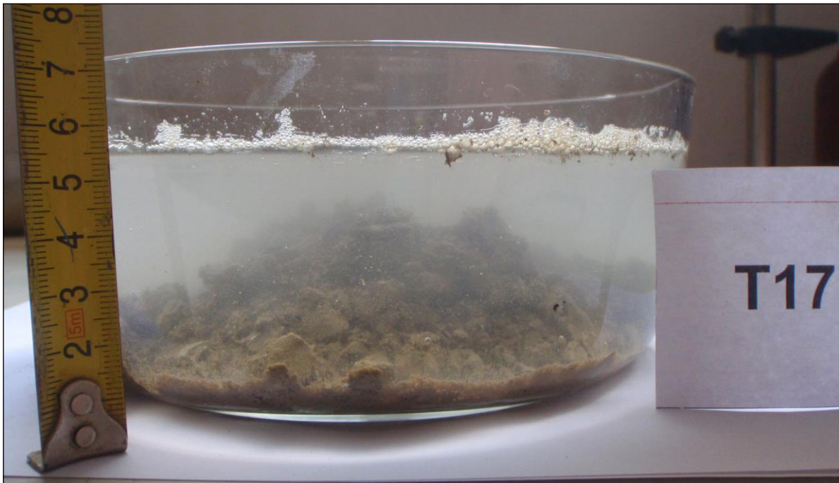
Slika 6-39. Degradacija nedisperzivnog uzorka oznake T17 nakon sušenja i potapljanja u vodi u trajanju od pola sata. Uzorak je u potpunosti dezintegriran u male odlomke, a izvorni oblik uzorka nije prepoznatljiv, što je prema slici 5-12 klasificirano kao klasa 3.
