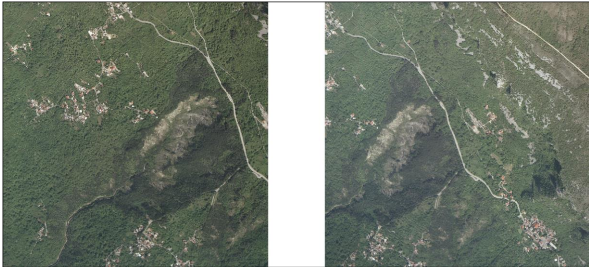
Slika 5-2. Primjer stereopara iz porječja Dubračine snimljen u svibnju 2006. godine. Mjerilo snimaka je 1 : 20 000.
