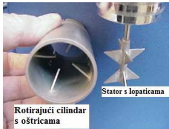
Slika 3-4. Dijelovi FYSA viskozimetra (Olowolagba i Brenneis, 2010)
