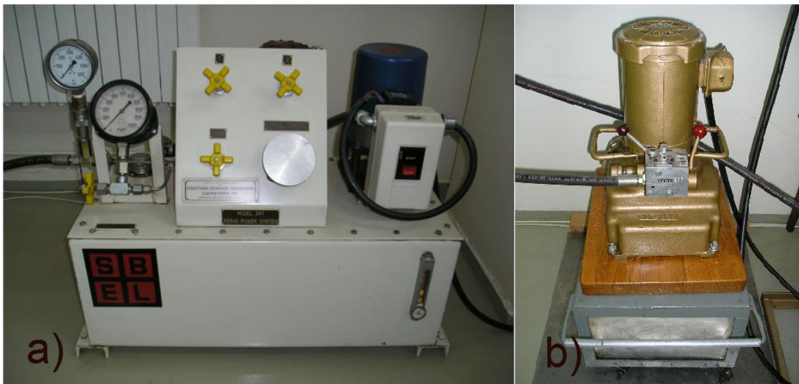
Slika 3-2. a) SBEL servo pumpa model 347, b) elektromotorna hidraulična pumpa SOILTEST
