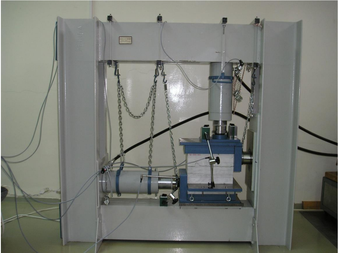
Slika 3-1. Prikaz uređaja za izravni posmik razvijenog na RGN fakultetu s ugrađenim uzorkom i mjernom opremom
