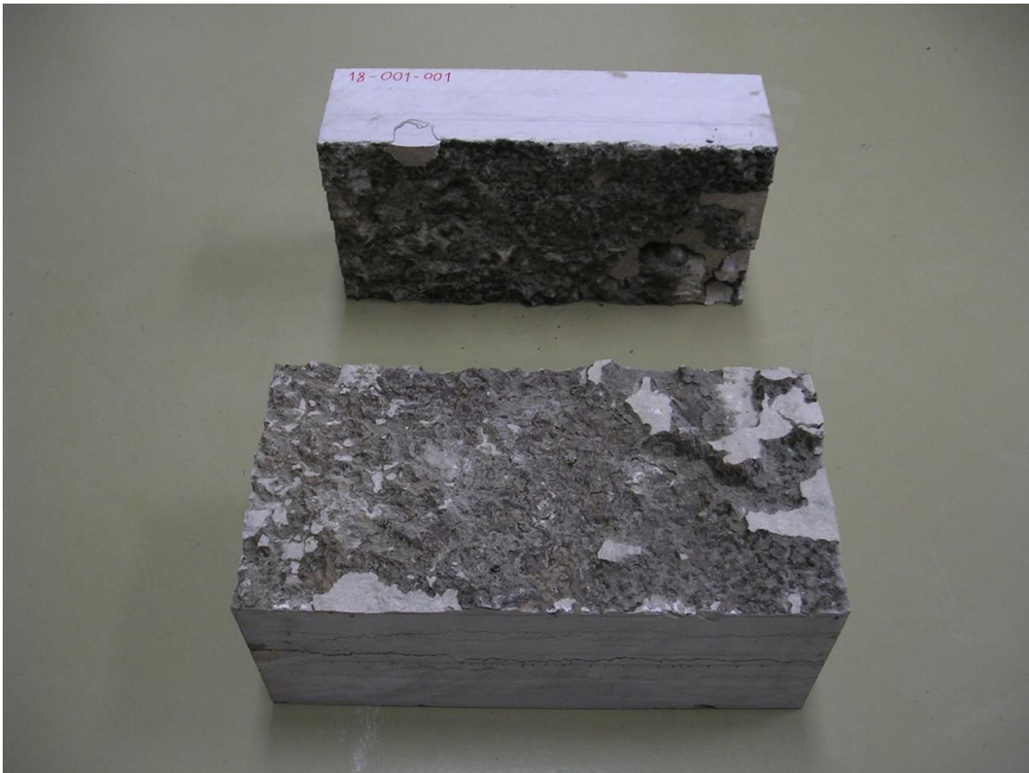
Slika 4-8. Prikaz prvog uzorka nakon sloma
