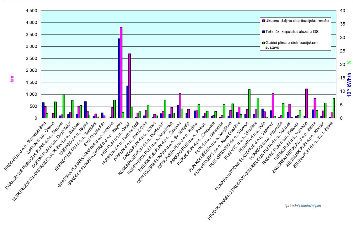
**Slika 2-3.** Usporedba duljine distribucijskih sustava, ukupnog tehničkog kapaciteta ulaza u distribucijske sustave i gubitaka plina po operatorima distribucijskog sustava u Republici Hrvatskoj u 2016. godini (Hera, 2017a)
