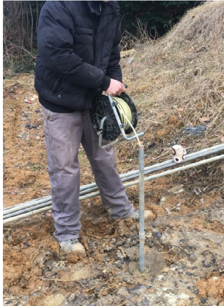
Slika 3.3 Mjerenje razine podzemne vode u bušotini B-3.
