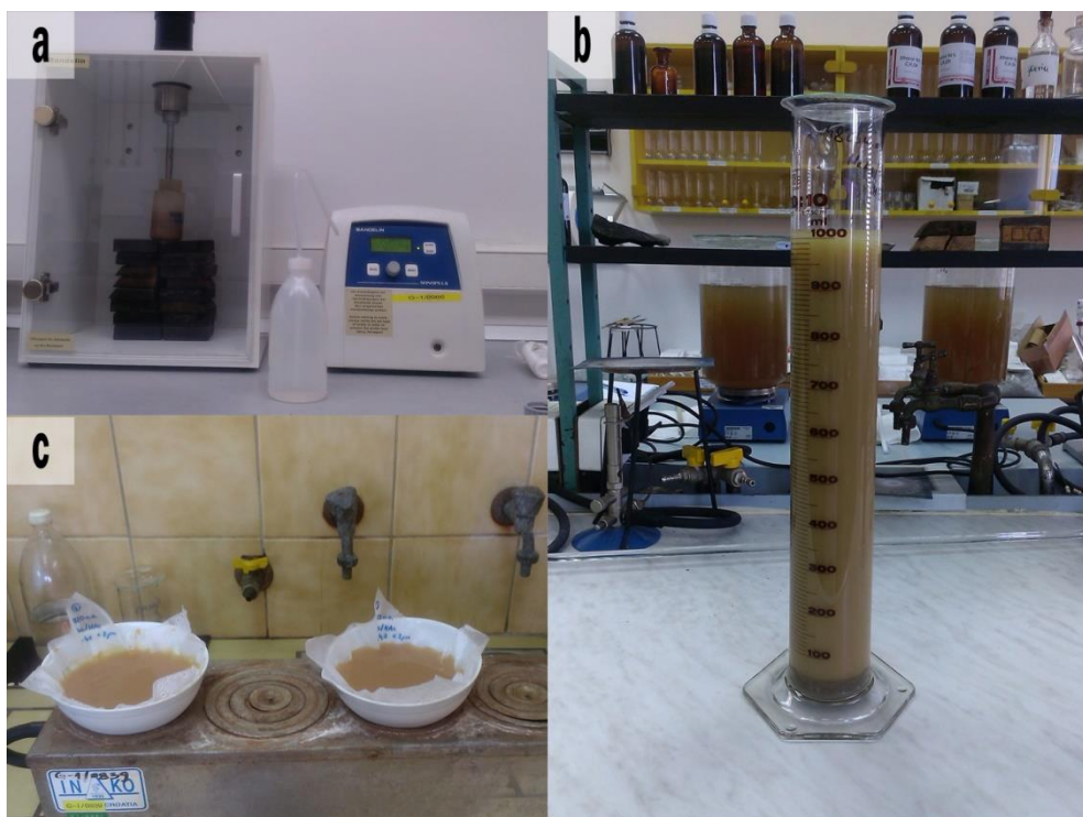
Slika 3.13. (a) Dispergiranje čestica pomoću ultrazvučnog štapa; (b) Izdvajanje frakcije < 2 \mu\text{m} pomoću cilindra; (c) Izdvojena suspenzija frakcije < 2 \mu\text{m} stavljena na kupelj na sušenje.
