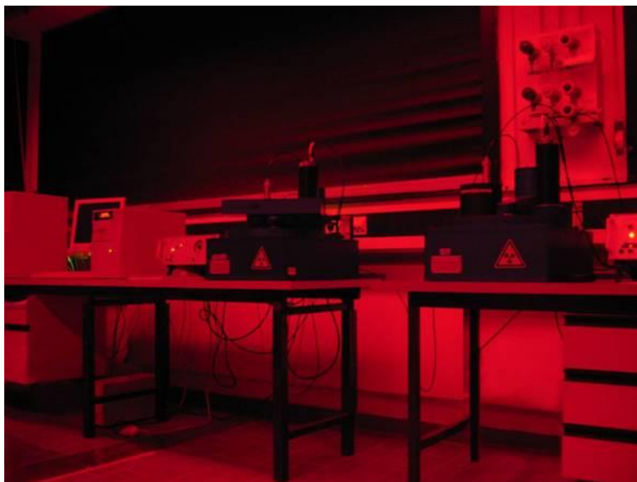
Slika 3.17. Uređaji za mjerenje luminiscencije Risø TL/OSL–DA 20 Readers u laboratoriju u LIAG-u.
