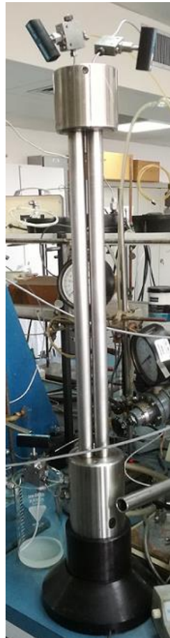
Slika 3-3. Fotografija i shematski prikaz akustičnog separatora (www.dcitestsystems.com, 2017; INA, d.d.)
