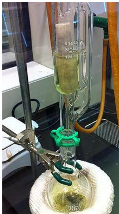
Slika 4-8. Soxhlet-ov ekstraktor s prikazom kruženja otapala (www.wikipedia.com, 2017)
