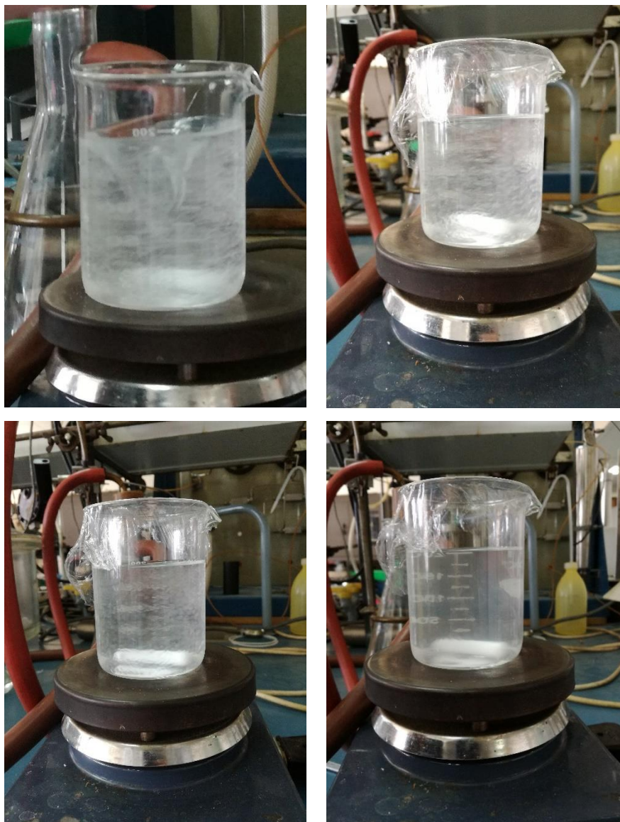
Slika 3-1. Prikaz miješanja polimerne otopine magnetskom miješalicom (nakon 0, 5, 10 i 60 minuta) (INA d.d.)
