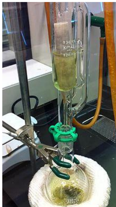
Slika 4-8. Soxhlet-ov ekstraktor s prikazom kruženja otapala (www.wikipedia.com, 2017)
