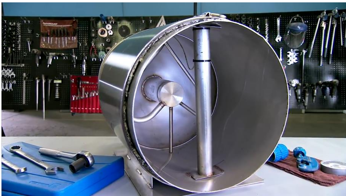
Slika 6-3. Presjek kamionskog spremnika UPP goriva (Agility systems, 2014.)
