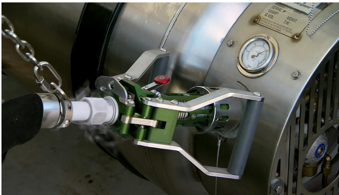
Slika 6-5. Punjenje spremnika UPP gorivom (Agility system, 2014.)
