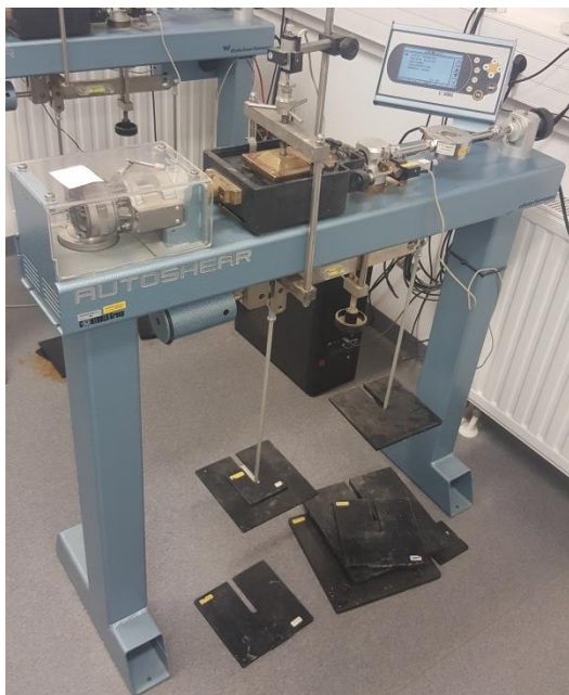
Slika 3-23. Postavljen kalup u uređaj za izravan posmik.
