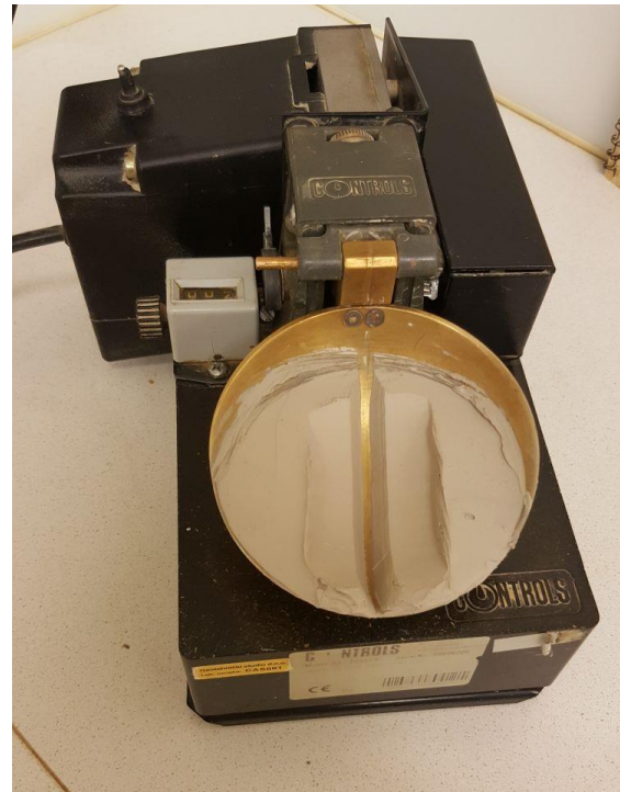
Slika 3-5. a) Priprema uzorka za Casagrandeov pokus, b) Casagrandeov uređaj s uzorkom
