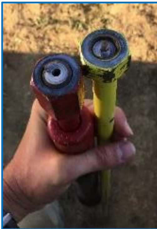
Slika 5.6: Prikaz puknuća sonde na terenu
