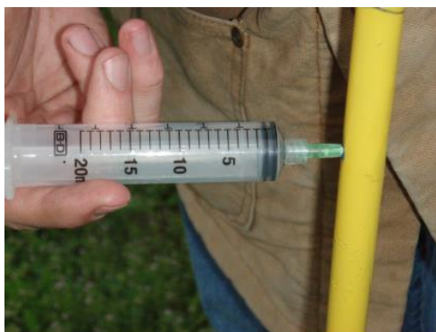
Slika 5.2: Prikaz injekcije za uzimanje uzorka i septum rupice (GeoFrontiers, 2018)
