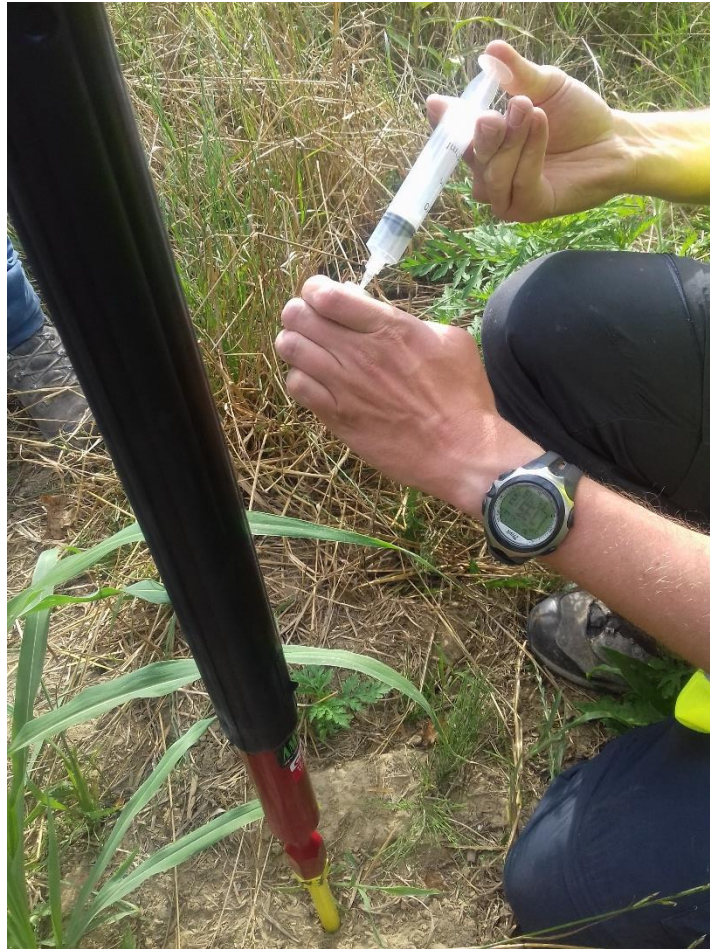
Slika 5.4: Primjer uzorkovanja plinova na terenu uz pomoć sonde
