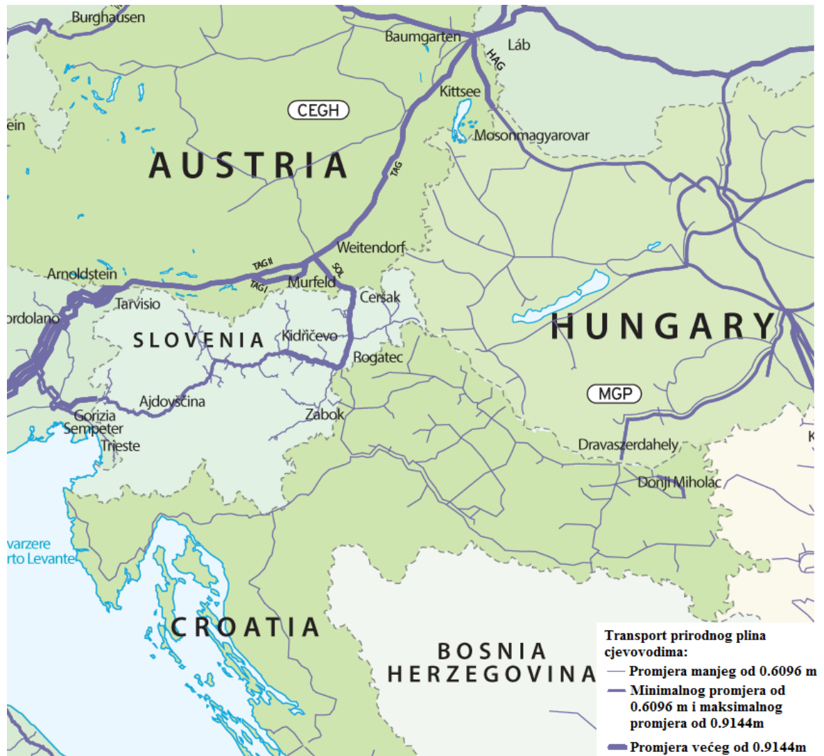
Slika 4-2. Regionalni plinski transportni sustav Republike Hrvatske (ENTSO-G, 2017)
