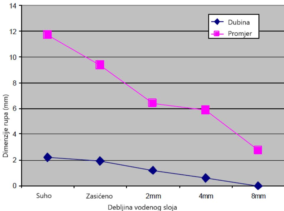
Slika 7-3. Dimenziije udubljenja kao funkcija debljine vodenog sloja iznad uzorka sivog Berea pješčenjaka zračenog Nd:YAG laserom, rasporeda E33L0,5R100 (Reed et al., 2003)
