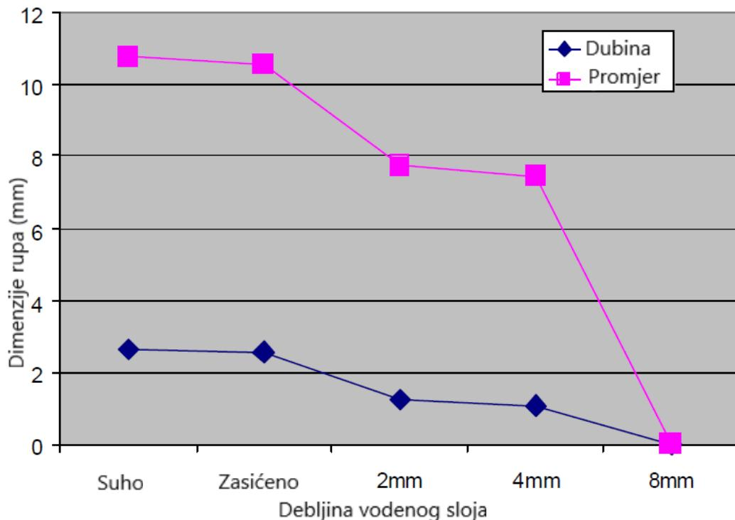
Slika 7-5. Dimenziije udubljenja kao funkcija debljine vodenog sloja iznad uzorka mulnjaka zračenog Nd:YAG laserom, raspoređa E32L0,5R100 (Reed et al., 2003)
