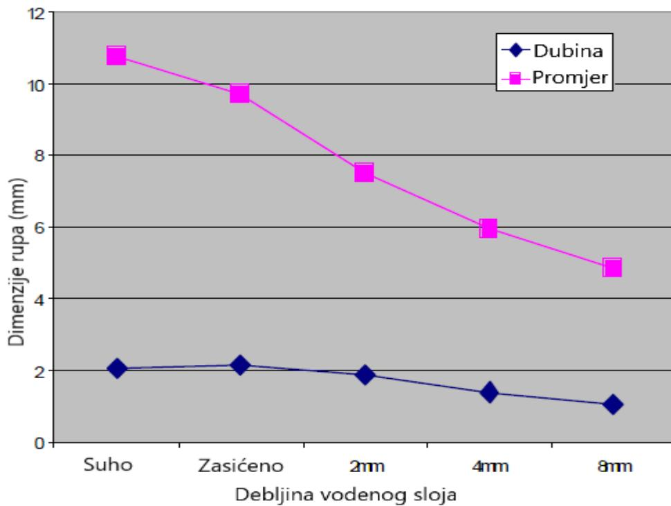
Slika 7-2. Dimenzijs udubljenja kao funkcija debljine vodenog sloja iznad uzorka sivog Berea pješčenjaka zračenog Nd:YAG laserom, rasporeda E8L2R100 (Reed et al., 2003)
