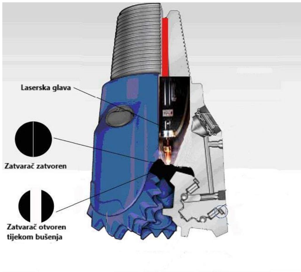
Slika 10-2. Poprečni presjek modificiranog žrvanjskog dlijeta (Pooniwala, 2006)
