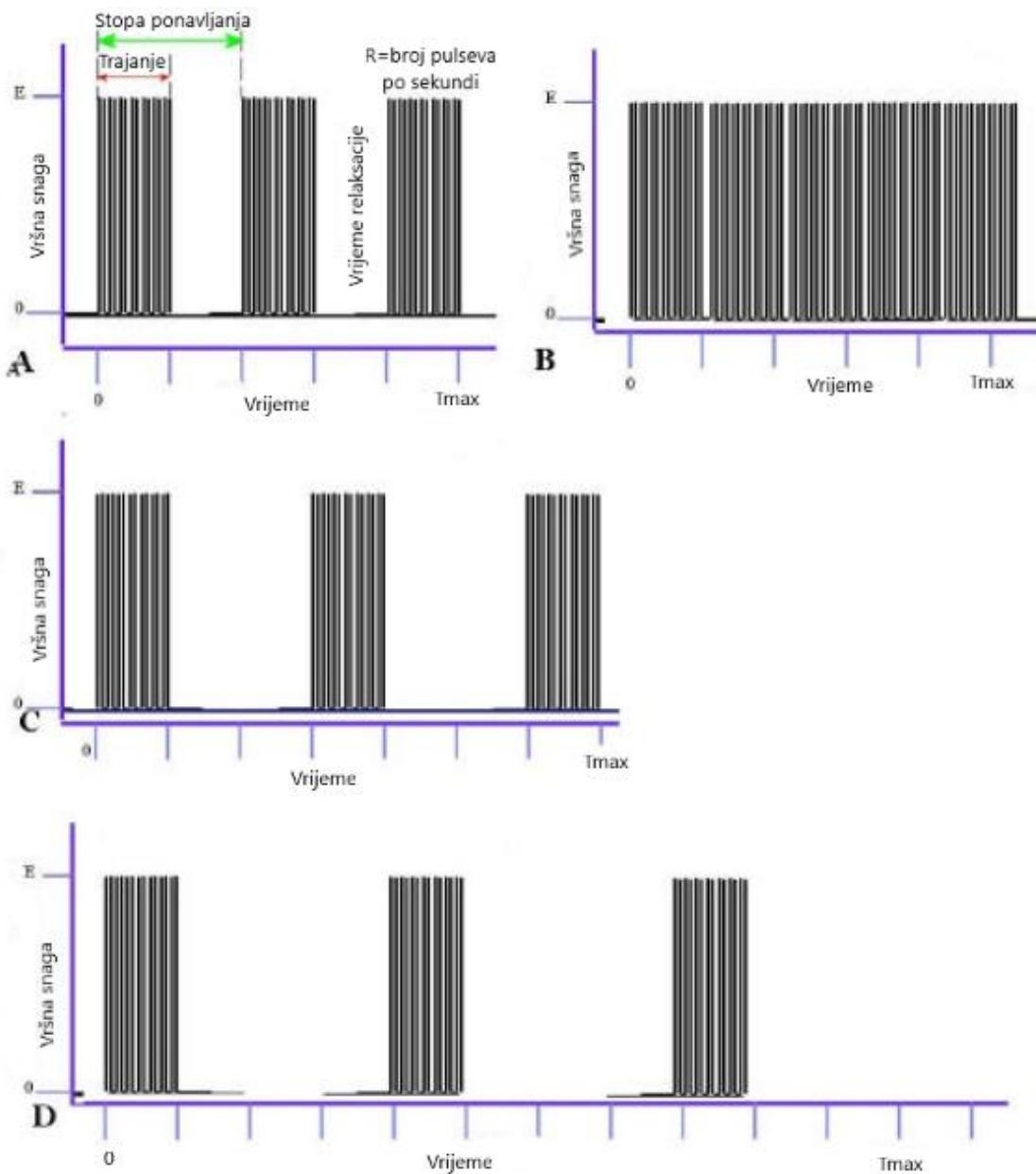
Slika 6-1. Shema uzoraka pulsiranja kod ispitivanja u više točaka (Reed et al., 2003)
