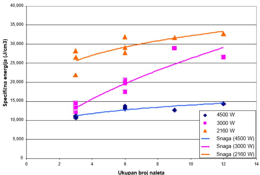
Slika 6-14. Ispitivanja CO<sub>2</sub> lasera na vapnencu (Reed et al., 2003)
