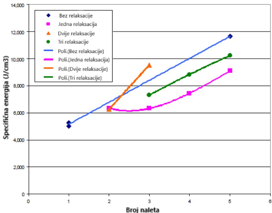
Slika 6-3. Ispitivanja u jednoj točki na uzorku pješčenjaka (Reed et al., 2003)
