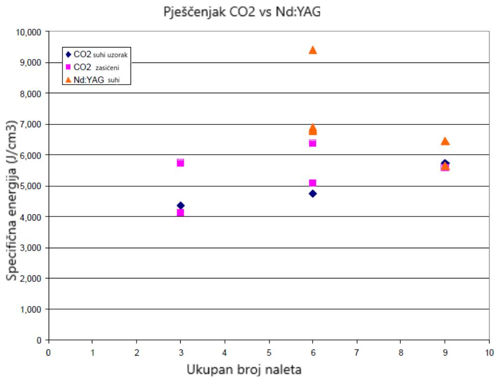
Slika 6-12. Usporedba između rezultata CO<sub>2</sub> i Nd:YAG lasera na pješčenjaku (Reed et al., 2003)
