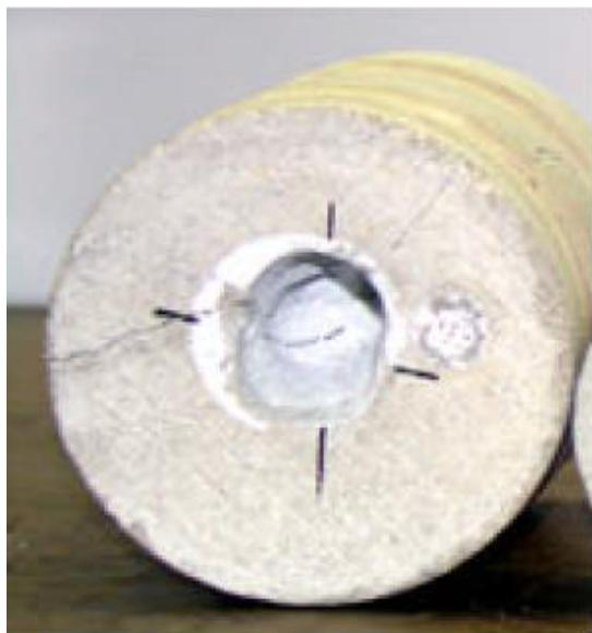
Slika 8-4. Udubljenje na uzorku vapnenca izrađena CO<sub>2</sub> laserom snage 4 kW (Reed et al., 2003)
