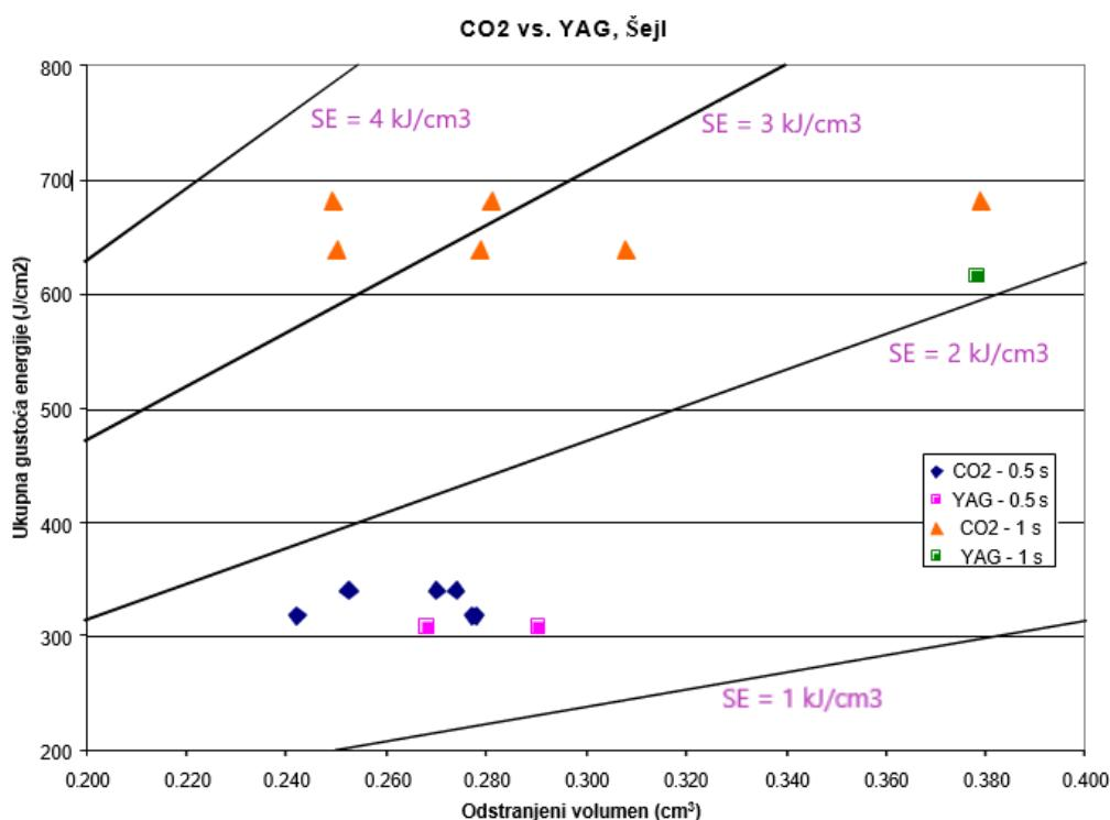
Slika 9-1. Usporedbe valnih duljina CO<sub>2</sub> i Nd:YAG lasera na uzorku šejla (Reed et al., 2003)
