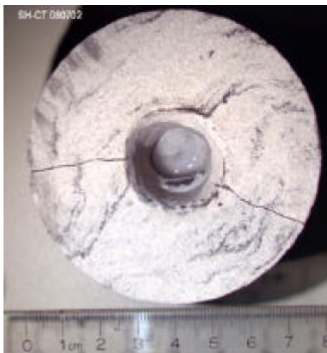
Slika 8-2. Udubljenje na uzorku šejla promjera 2,54 cm i dubine 4,57 cm izbušena CO 2 laserom s četiri naleta u trajanju od 4 sekunde (Reed et al., 2003)
