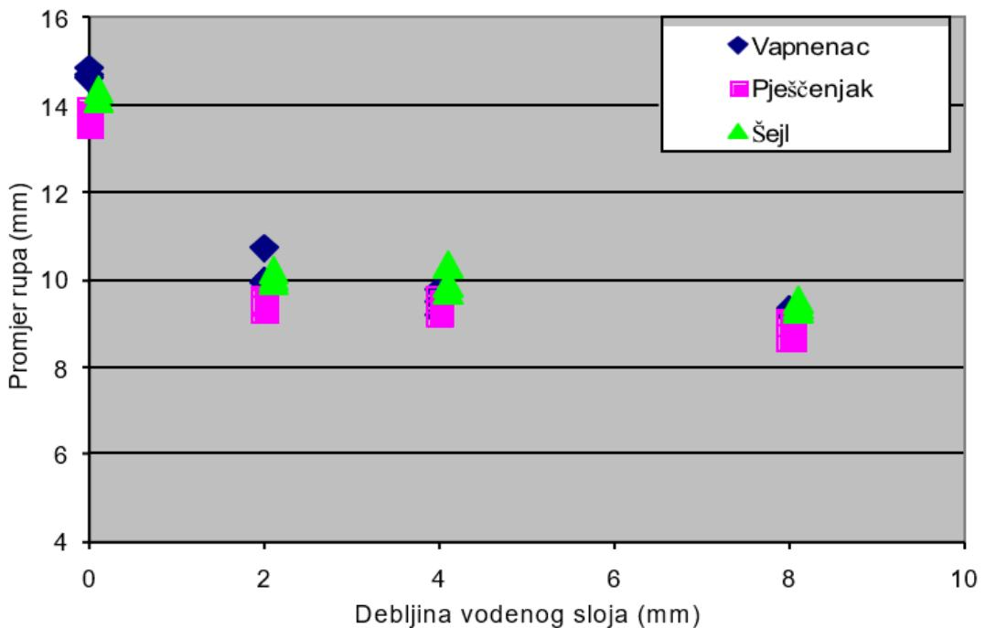
Slika 7-7. Dimenzije udubljenja kao funkcija debljine vodenog sloja iznad uzorka vapnenca, pješčenjaka i šejla zračenih CO<sub>2</sub> laserom u kontinuiranom režimu snage 4 kW (Reed et al., 2003)
