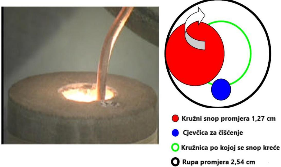
Slika 8-3. Skica kružnog gibanja snopa (desno) i slika izbušenog udubljenja metodom kružnog snopa (lijevo) (Reed et al., 2003)
