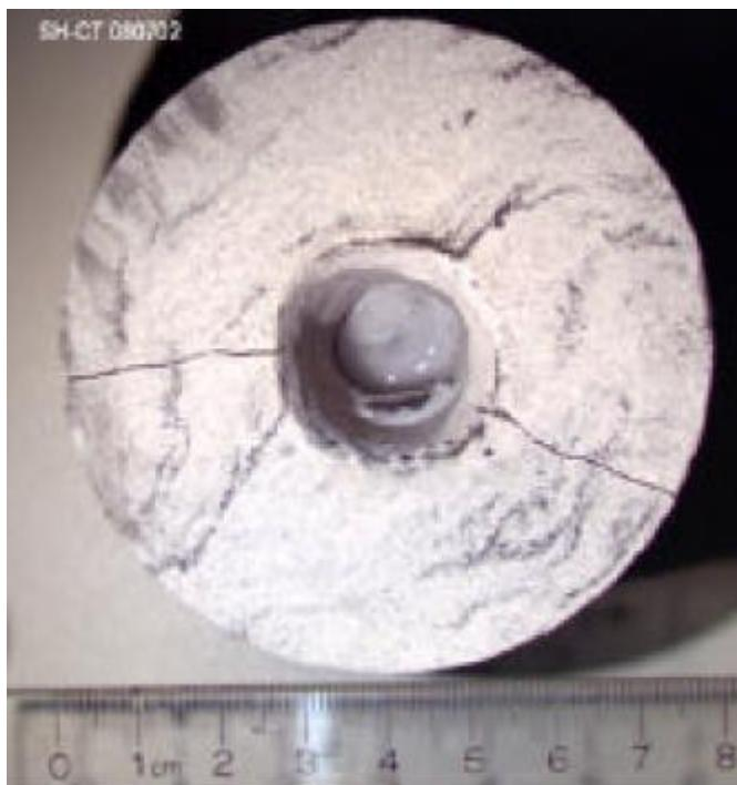
Slika 8-2. Udubljenje na uzorku šejla promjera 2,54 cm i dubine 4,57 cm izbušena CO<sub>2</sub> laserom s četiri naleta u trajanju od 4 sekunde (Reed et al., 2003)
