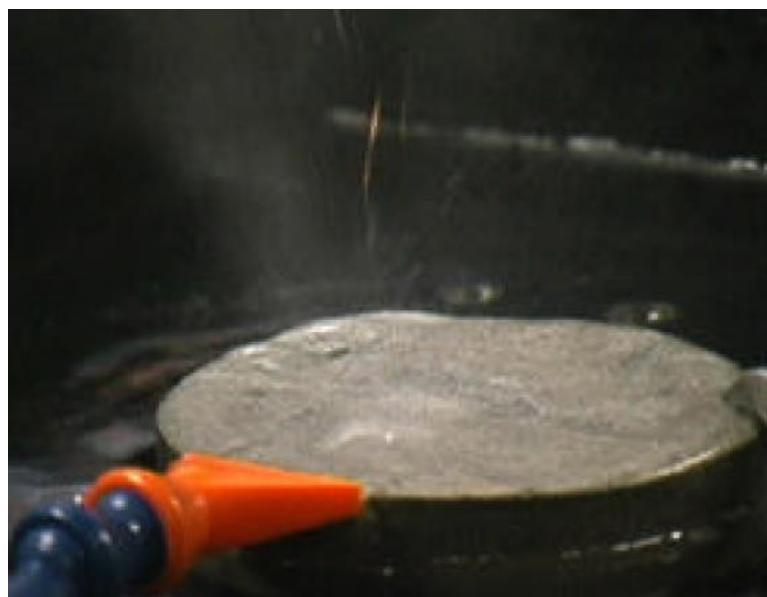
Slika 7-10. Neuspjeli pokušaj laserskog snopa CO<sub>2</sub> lasera da razruši uzorak stijene (Reed et al., 2003)
