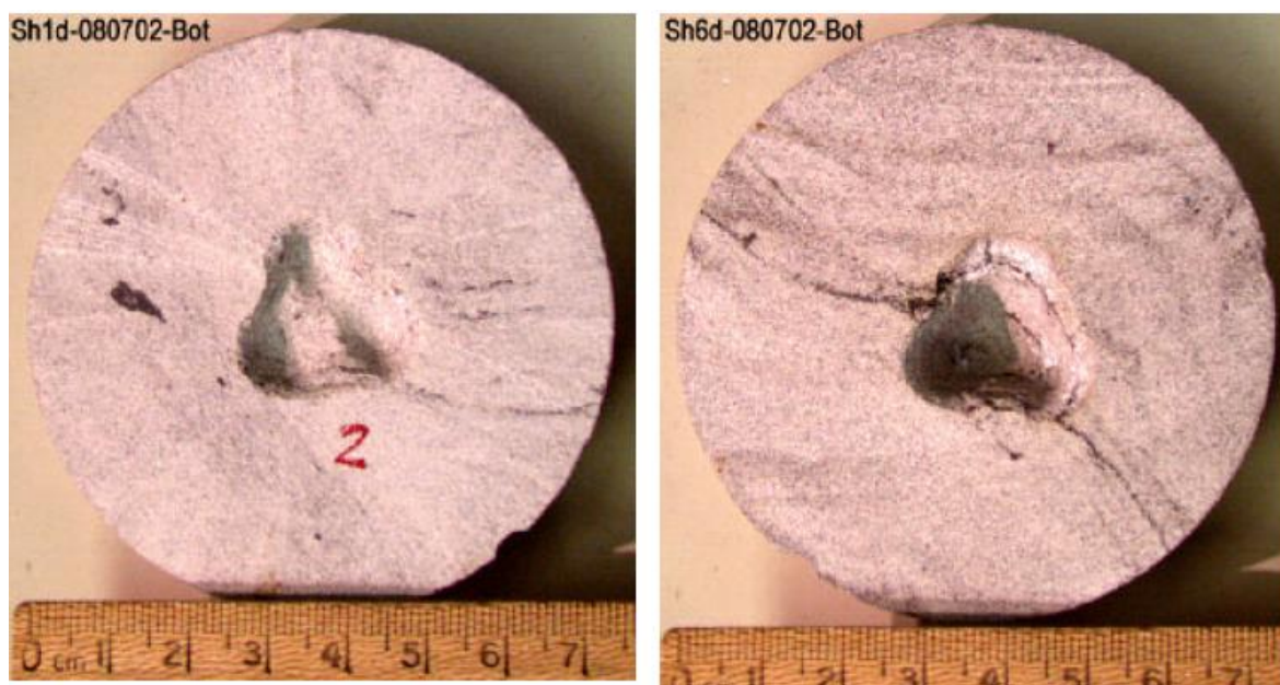
Slika 6-11. Najniža dobivena vrijednost specifične energije (SH1D-2, lijevo) i najviša vrijednost specifične energije (SH6D, desno) (Reed et al., 2003)
