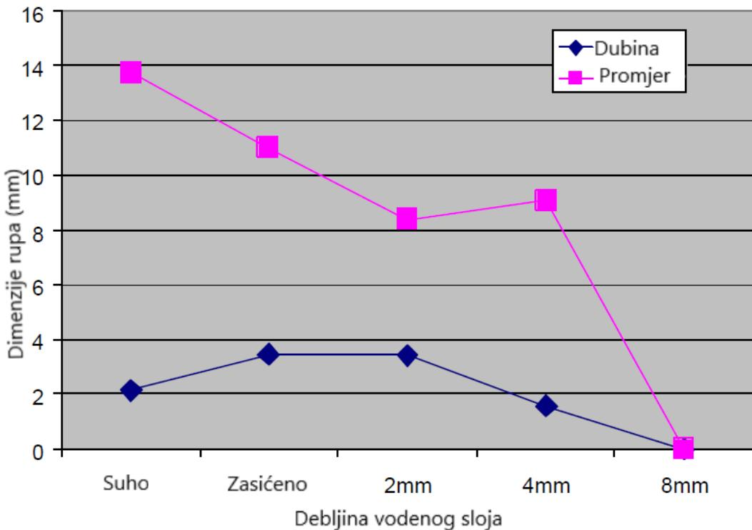
Slika 7-6. Dimenziije udubljenja kao funkcija debljine vodenog sloja iznad uzorka šejla zračenog Nd:YAG laserom, rasporeda E32L0,5R100 (Reed et al., 2003)
