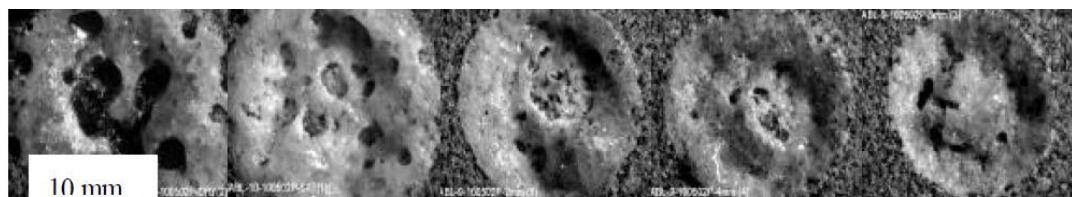
Slika 7-8. Udubljenja izbušena na uzorku šejla CO<sub>2</sub> laserom u kontinuiranom režimu snage 4 kW (Reed et al., 2003)
