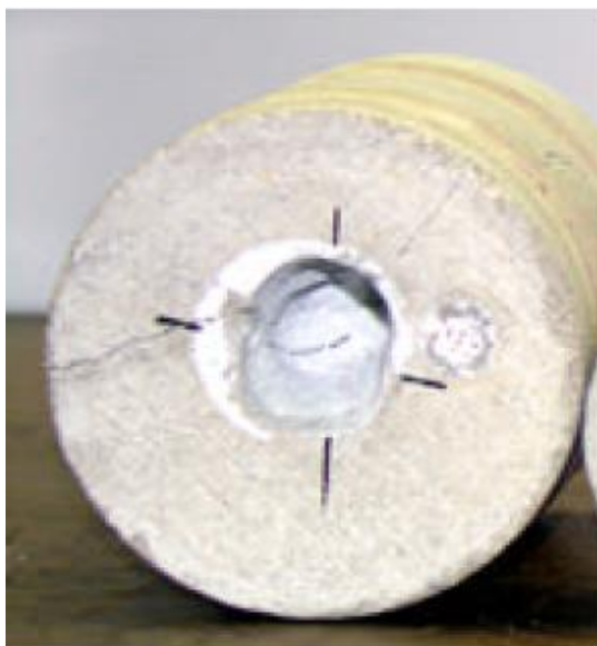
Slika 8-4. Udubljenje na uzorku vapnenca izrađena CO 2 laserom snage 4 kW (Reed et al., 2003)
