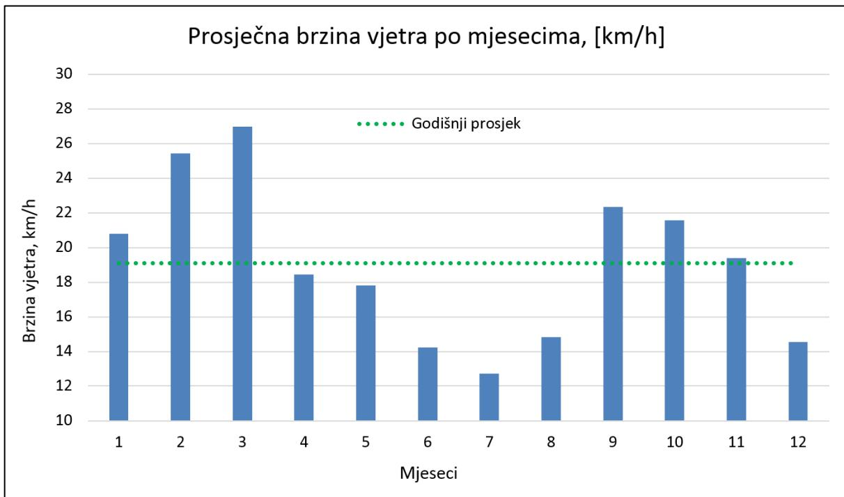
Slika 7-1. Iznosi srednjih mjesecnih brzina vjetra. Brzine izvan radnog raspona vjetroelektrane *NREL 5MW Offshore* izjednačene su s nulom (Klabučar i Aščić 2018)
