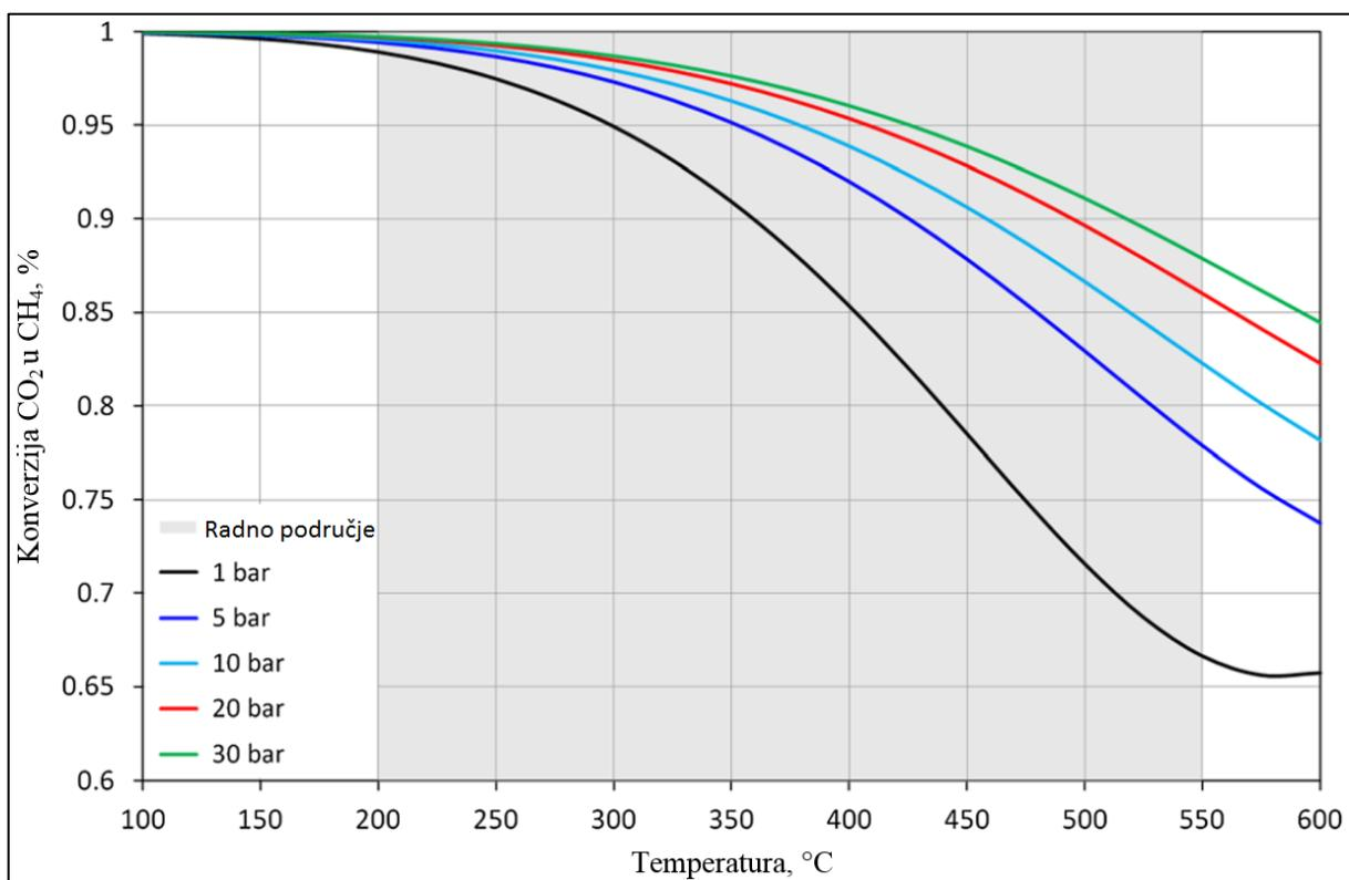
Slika 5-3. Prikaz ovisnosti konverzije  $CO_2$  u  $CH_4$  o tlaku i temperaturi (Schaaf et al., 2014).
