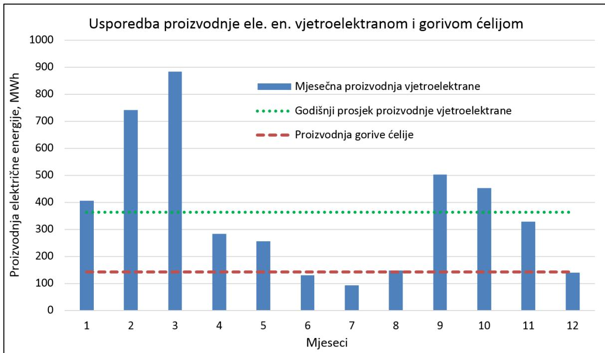
Slika 7-9. Usporedba proizvodnje el. energije vjetroelektrane s kontinuiranom proizvodnjom gorive čelije (Klabučar i Aščić 2018)
