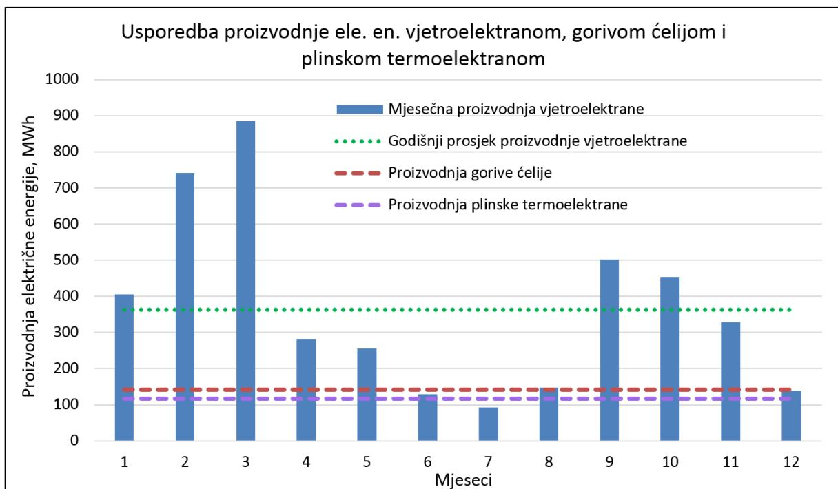
Slika 7-12. Usporedba u proizvodnji el. energije raznim tehnologijama; vjetroelektranom, gorivim čelijama i plinskom termoelektranom [MWh<sub>e</sub>] (Klabučar i Aščić 2018)
