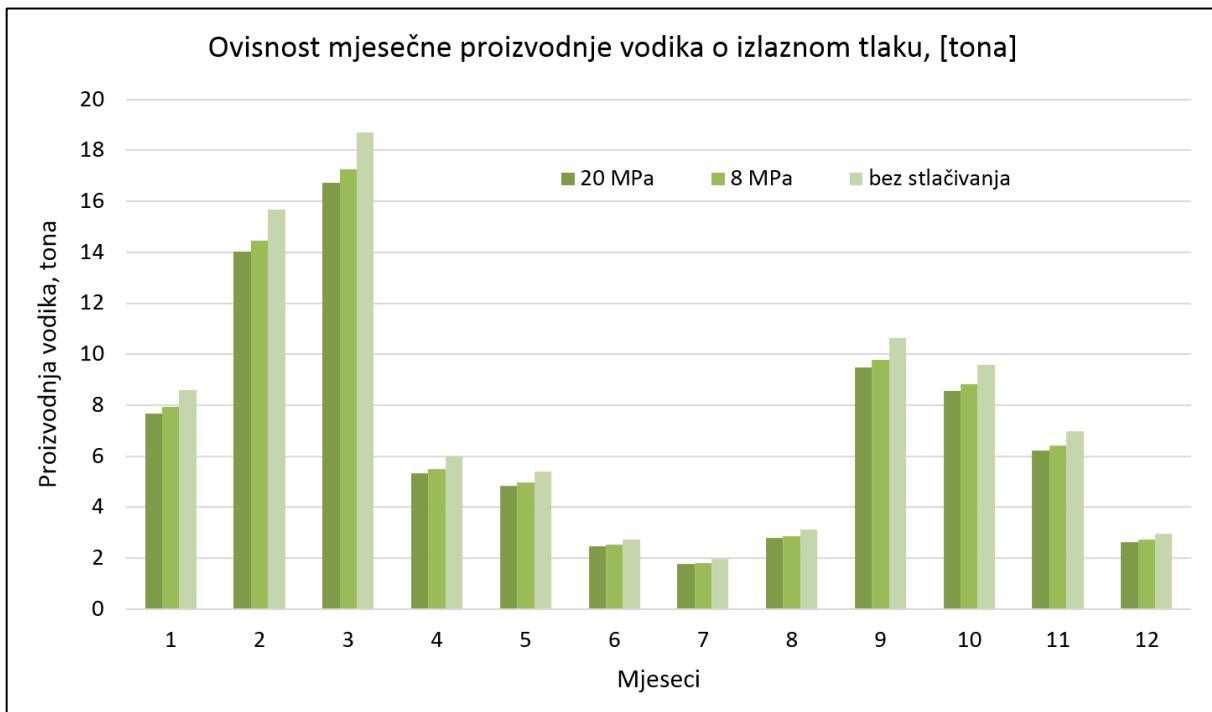
Slika 7-6. Grafički prikaz zavisnosti izlaznog tlaka o prosječnoj mjesecnoj proizvodnji vodika [tona] (Klabučar i Aščić 2018)
