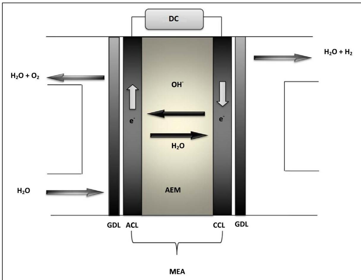
Slika 5-2. Shematski prikaz AEM elektrolize (Vincent i Bessarabov 2018)
