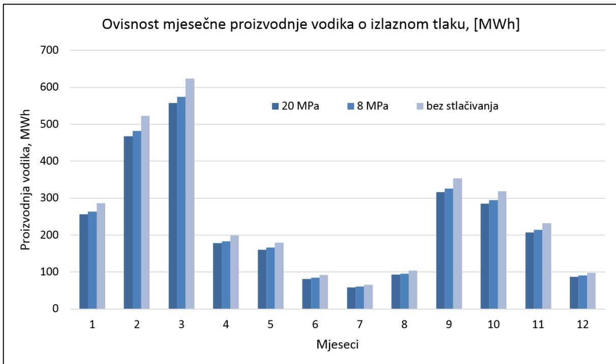
Slika 7-5. Grafički prikaz zavisnosti izlaznog tlaka o prosječnoj mjesecnoj proizvodnji vodika [MWh<sub>t</sub>] (Klabučar i Aščić 2018)
