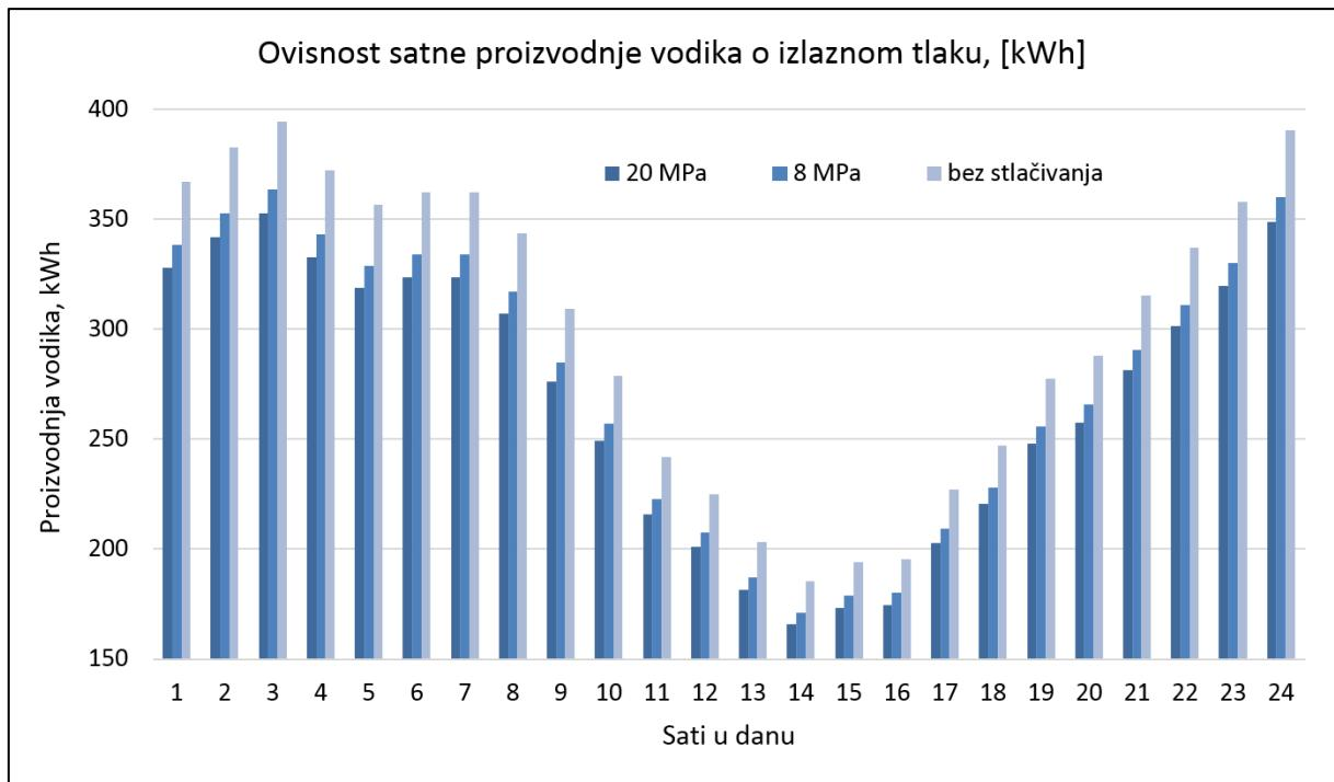
Slika 7-7. Grafički prikaz zavisnosti izlaznog tlaka o satnoj proizvodnji vodika [kWh<sub>t</sub>] (Klabučar i Aščić 2018)
