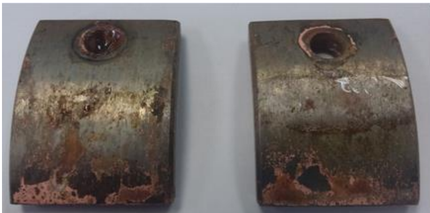
Slika 4-8. Kuponi uronjeni u otopinu bakrova sulfida nakon 8 dana ispitivanja (INA d.d., 2017 b)
