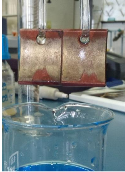
Slika 4-7. Kuponi uronjeni u otopinu bakrova sulfida nakon 8 dana ispitivanja (INA d.d., 2017 b)
