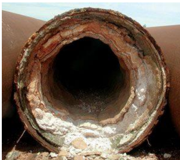
Slika 4-11. Taloženje kamenca u metalnoj cijevi (Envirofluid, 2014 a)
