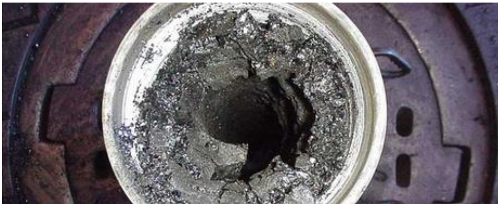
Slika 4-12. Taloženje parafina unutar tubinga (Envirofluid, 2014 b)
