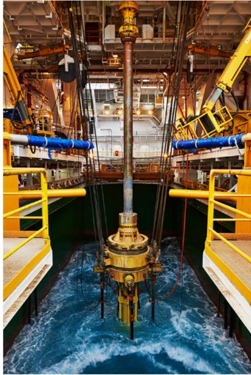
Slika 2-2. Središnji otvor na trupu bušaćeg broda (engl. moon pool ) (www.flickr.com, 2014)
