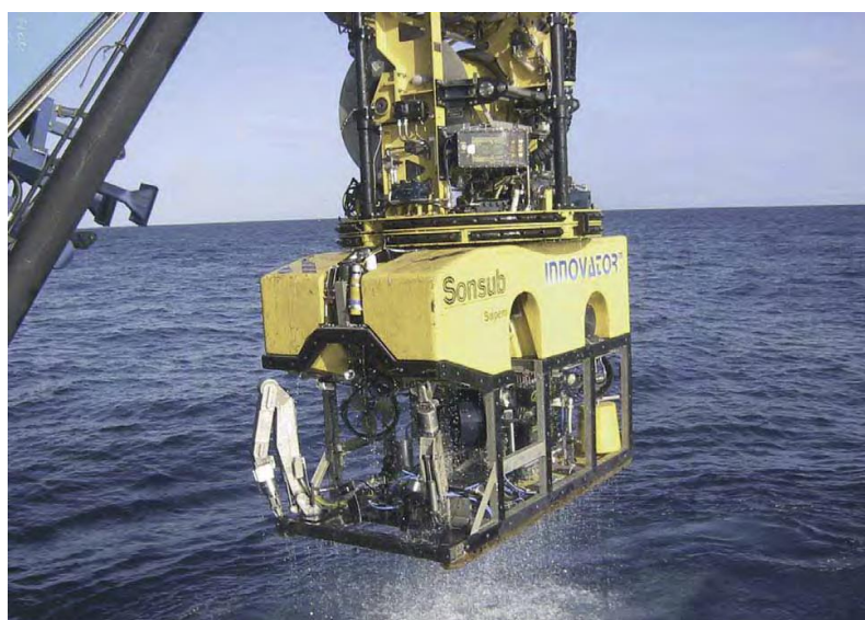
Slika 2-10. Daljinski upravljana podvodna ronilica (Kongsberg Maritime AS, 2006)
