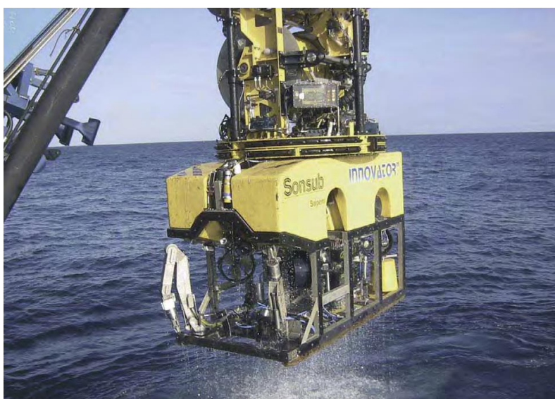
Slika 2-10. Daljinski upravljana podvodna ronilica (Kongsberg Maritime AS, 2006)
