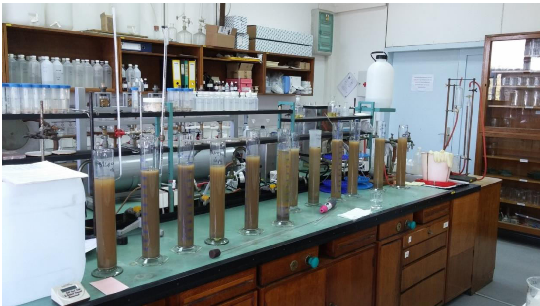
Slika 5-5. Cilindri s uzorcima u suspenziji spremni za pipetiranje
