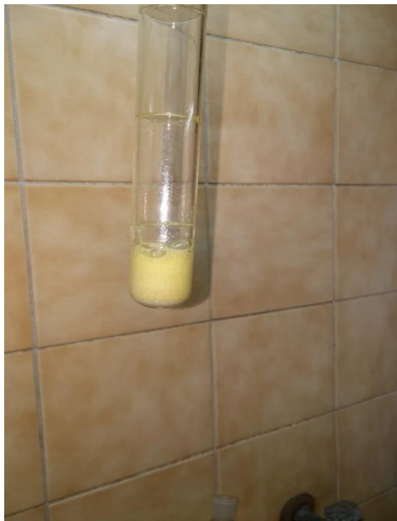
Slika 5-10. Burna reakcija uzorka sa zlatotopkom
