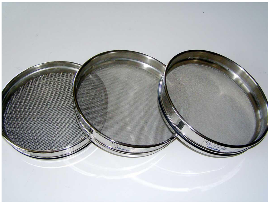
Slika 5-4. Sustav sita za sijanje
