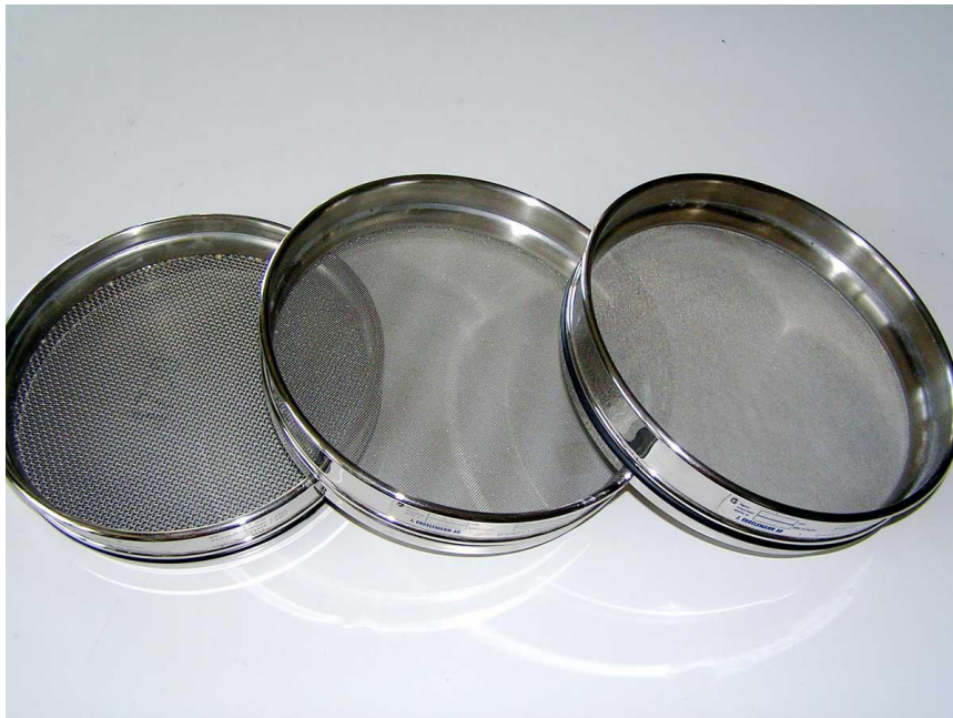
Slika 5-4. Sustav sita za sijanje
