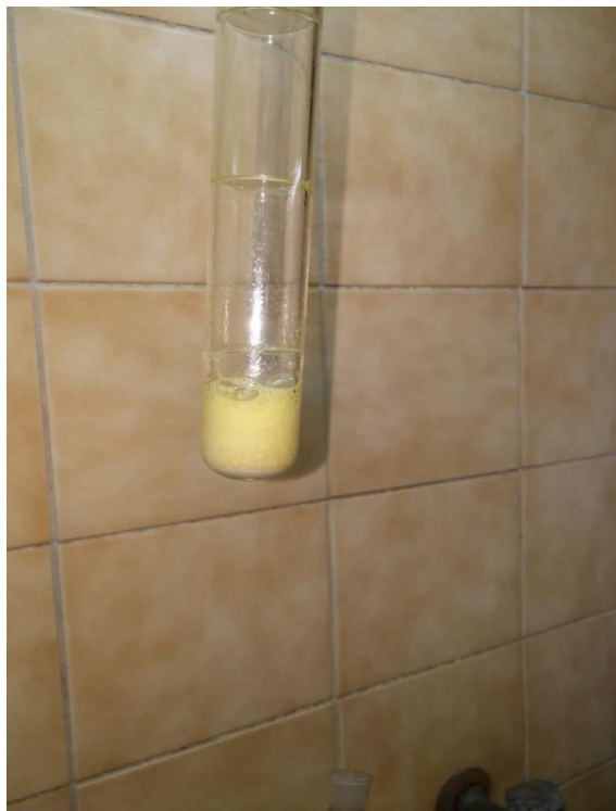
Slika 5-10. Burna reakcija uzorka sa zlatotopkom
