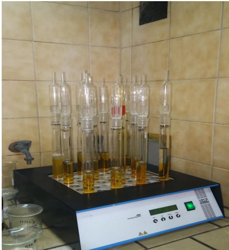
Slika 5-9. Reakcijske epruvete sa klopkom na grijaču
