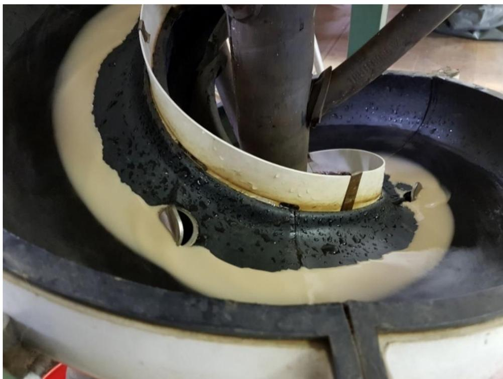
*Slika 4-14 Ispitivanje na spiralnom žlijebu – bliži prikaz*
