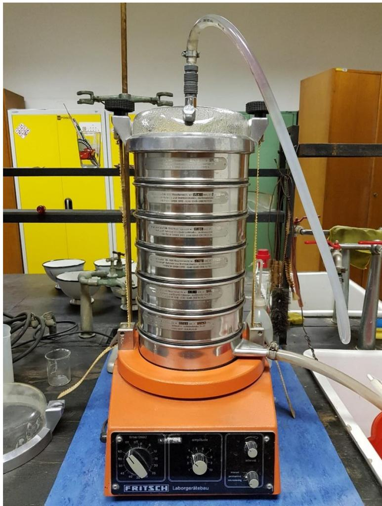
Slika 4-1 Vibracijsko sito „FRITSCH – Analysette 3“
