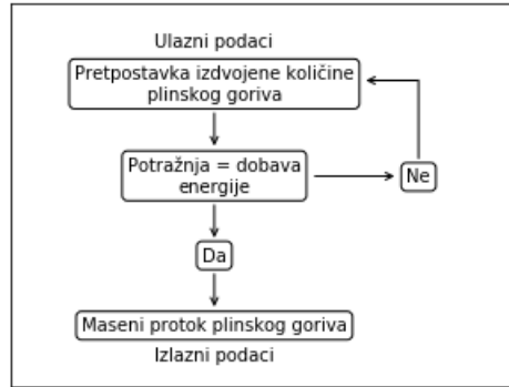
Slika 3-2. Prikaz algoritma modeliranja izdvojene količine plinskog goriva
