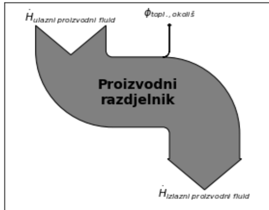
Slika 3-5. Prikaz energetske bilance podsustava proizvodnog razdjelnika
