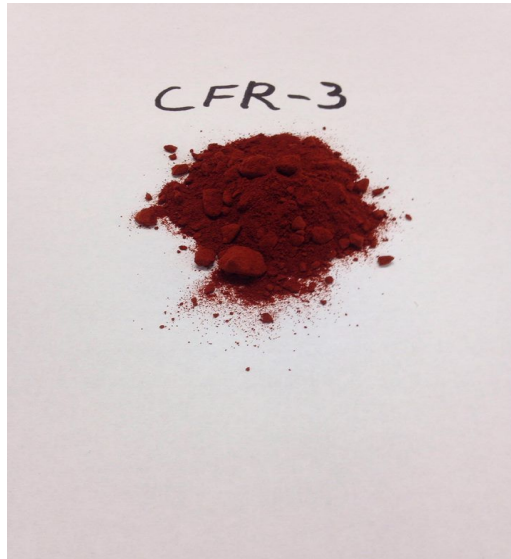
Slika 5-2. Dispergator CFR-3 kompanije Halliburton
