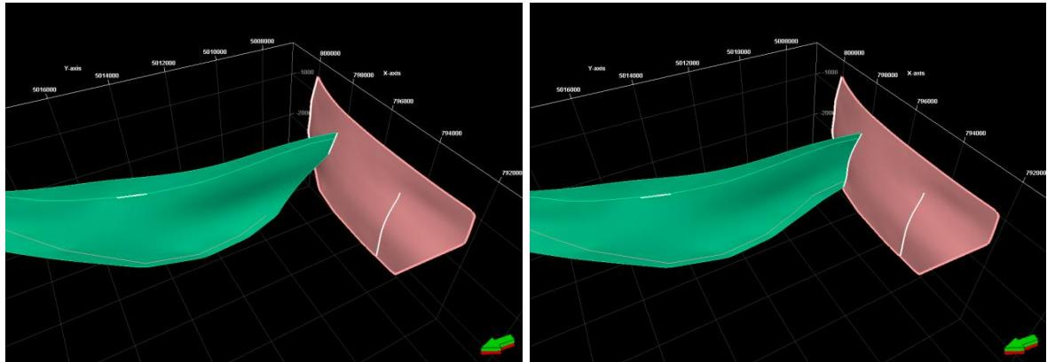
**Slika 4-14 (a i b).** Lijeva (a) slika prikazuje mlađi rasjed s nepotpunim kontaktom sa starijim rasjedom. Desno (b) je prikaz istih rasjeda nakon popravljanja kontakta.
