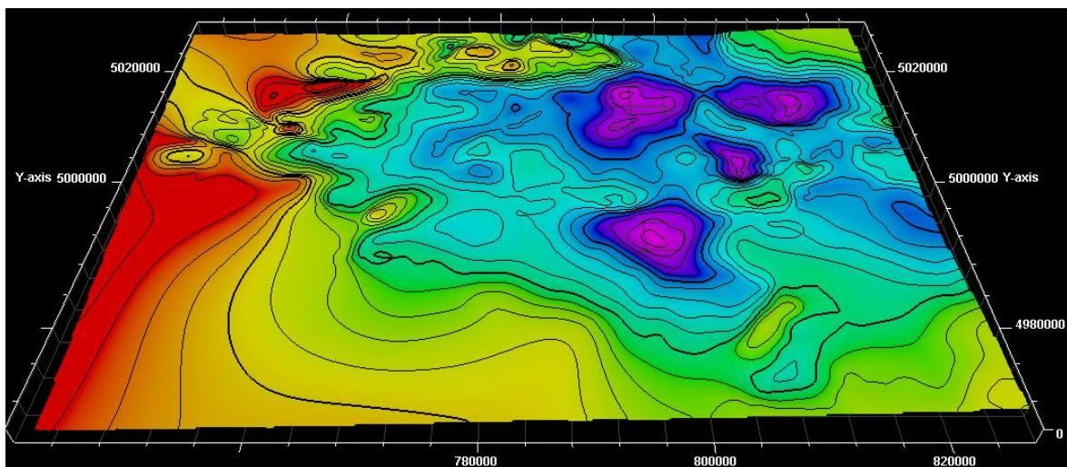
Slika 4-5. Površina modelirana od stratoizohipsa horizonta A.
