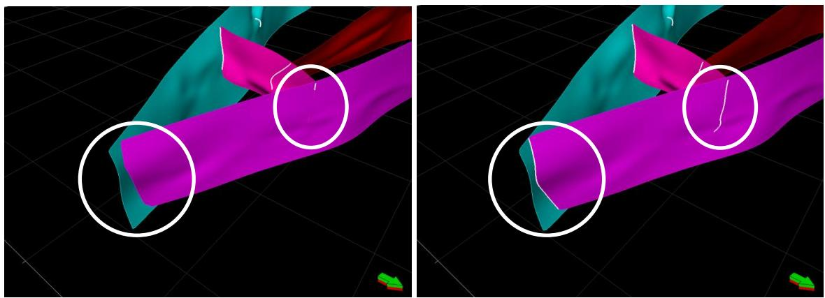
**Slika 4-15 (a i b).** Primjer popravljanja kontakta među rasjedima povećanjem udaljenosti ekstrapolacije. Bijela linija na kontaktu znači da je kontakt potpun.
