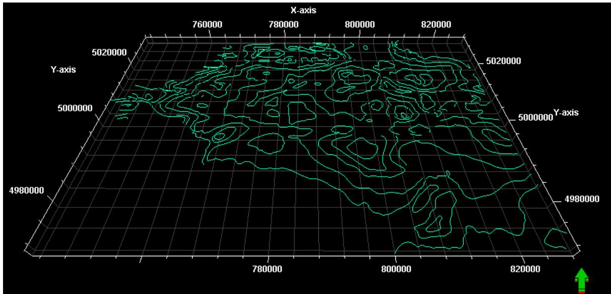
Slika 4-4. 3D prikaz digitaliziranih stratoizohipsa na horizontu A.
