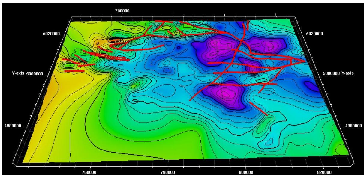
**Slika 4-6.** Rasjedi sa strukturne karte A nakon što su „zalijepeni“ na plohu horizonta A.
