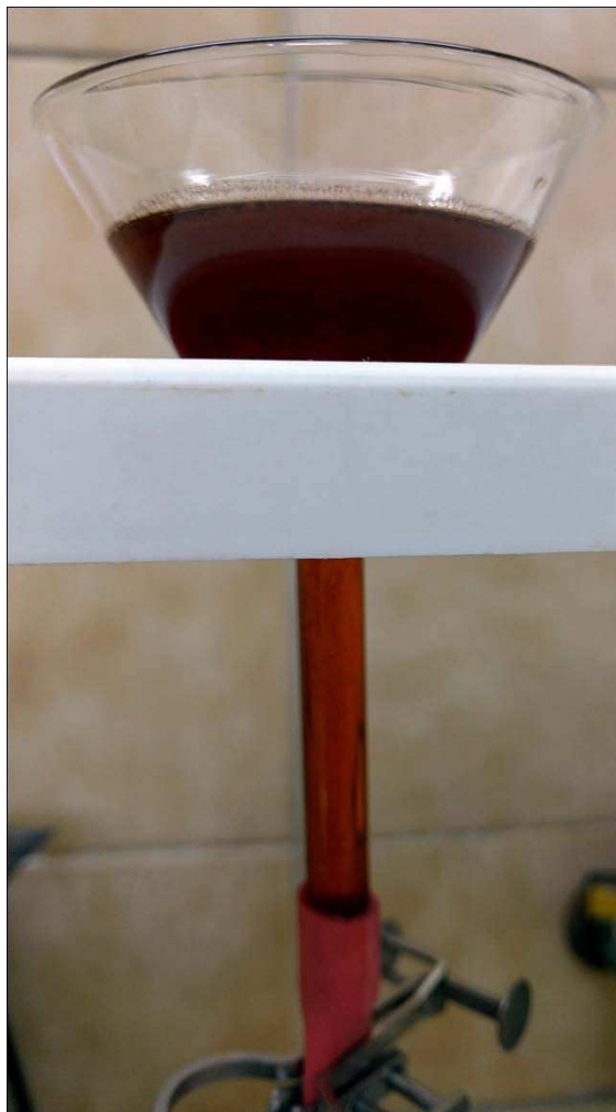
Slika 3.6. Separacija teške mineralne frakcije pomoću bromoforma.
