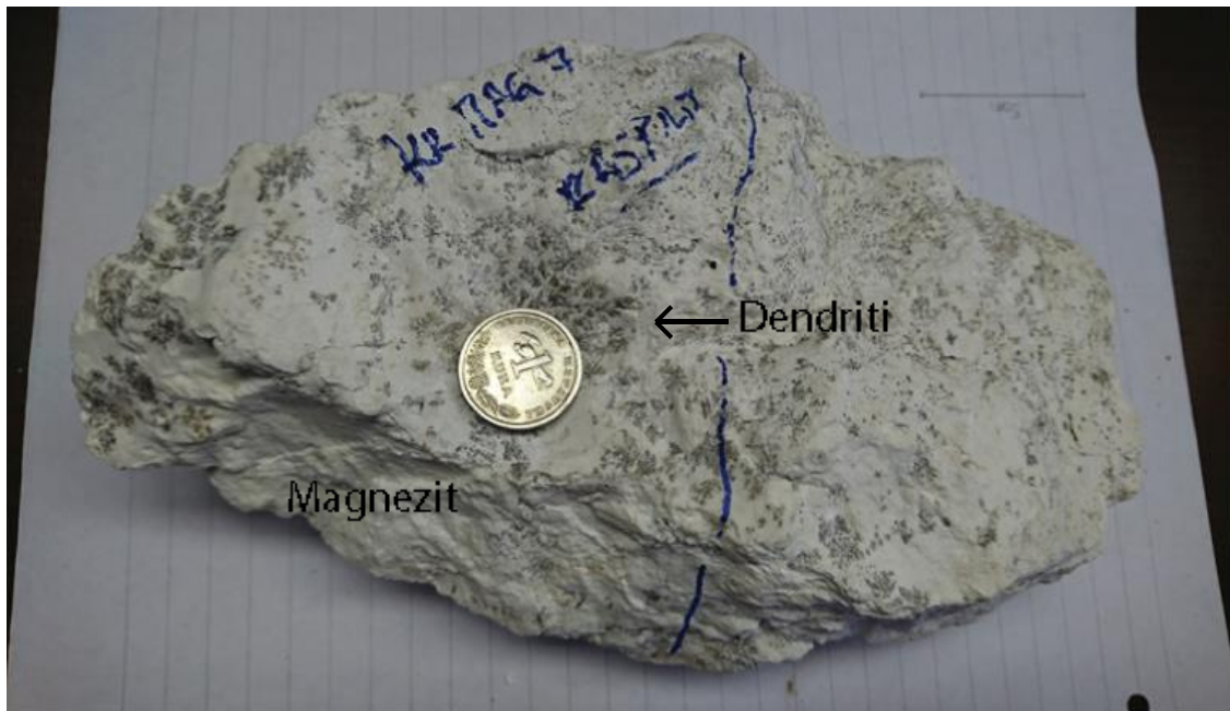
Slika 5.4. Uzorak čistog magnezita.
