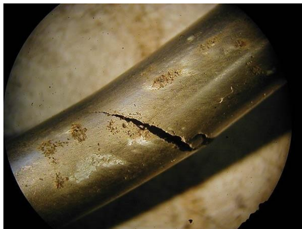
Slika 2-2. Primjer pukotinske korozije (Sachs, N. 2018, Efficient Plant, Corrosion: Undertand It to Fight It)
