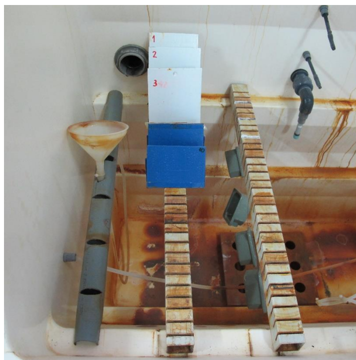
Slika 7-3. Ispitivani uzorci smješteni u slanoj komori
