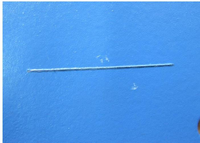
Slika 7-4. Rez napravljen na uzorku prije stavljanja u slanu komoru
