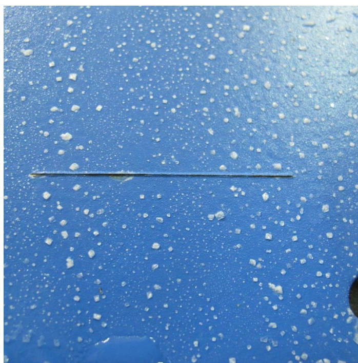
Slika 7-5. Uzorak s urezom nakon tretiranja u slanoj komori
