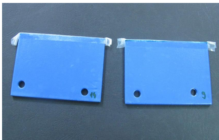
Slika 7-7. Uzorci nakon tretiranja u vlažnoj komori bez uočenih promjena izgleda premaza
