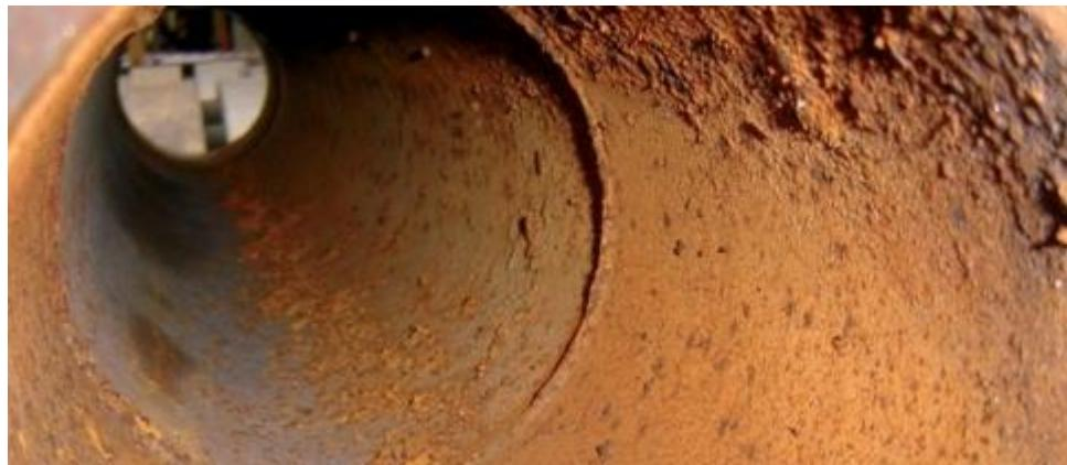
Slika 2-3. Opća korozija u cjevovodu (Minero, C. 2011, Laboratorio de Corrosao e Protecao – LCP)
