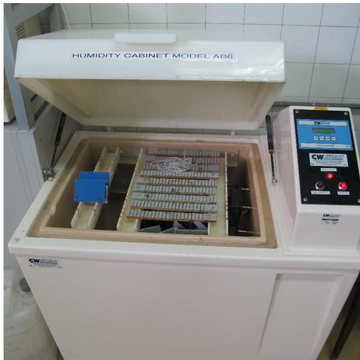
Slika 7-6. Uzorci smješteni u vlažnoj komori
