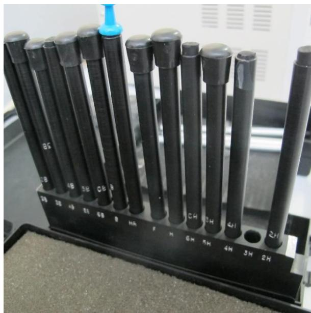
Slika 5-1. Set olovaka za ispitivanje tvrdoće premaza
