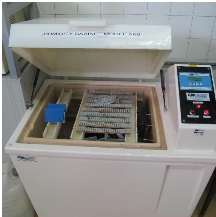
Slika 7-6. Uzorci smješteni u vlažnoj komori
