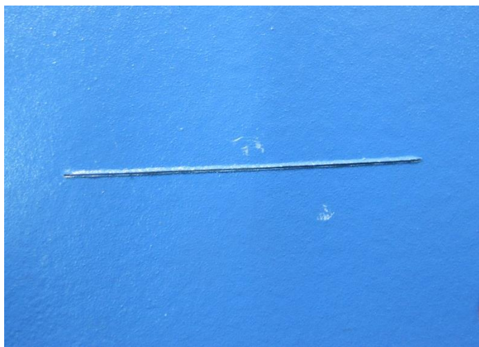
Slika 7-4. Rez napravljen na uzorku prije stavljanja u slanu komoru
