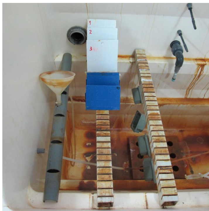
Slika 7-3. Ispitivani uzorci smješteni u slanoj komori
