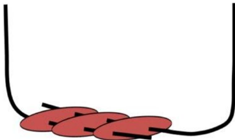
**Slika 5-1.** EGS koncept s horizontalnom utisnom i proizvodnom buštinom međusobno povezanim s jednostrukim frakturama (Li i sur., 2014)
