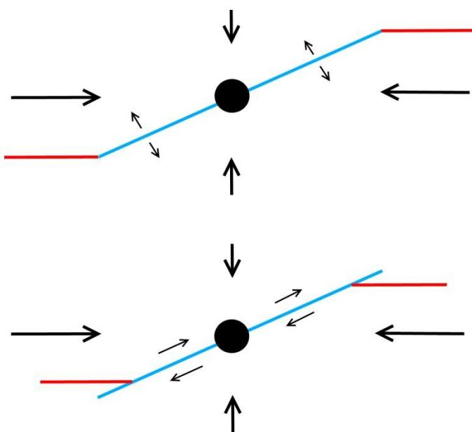
**Slika 4-4.** Shematski prikaz novih frakturna koje nastaju od postojećih frakturna (McClure i Horne, 2014)
