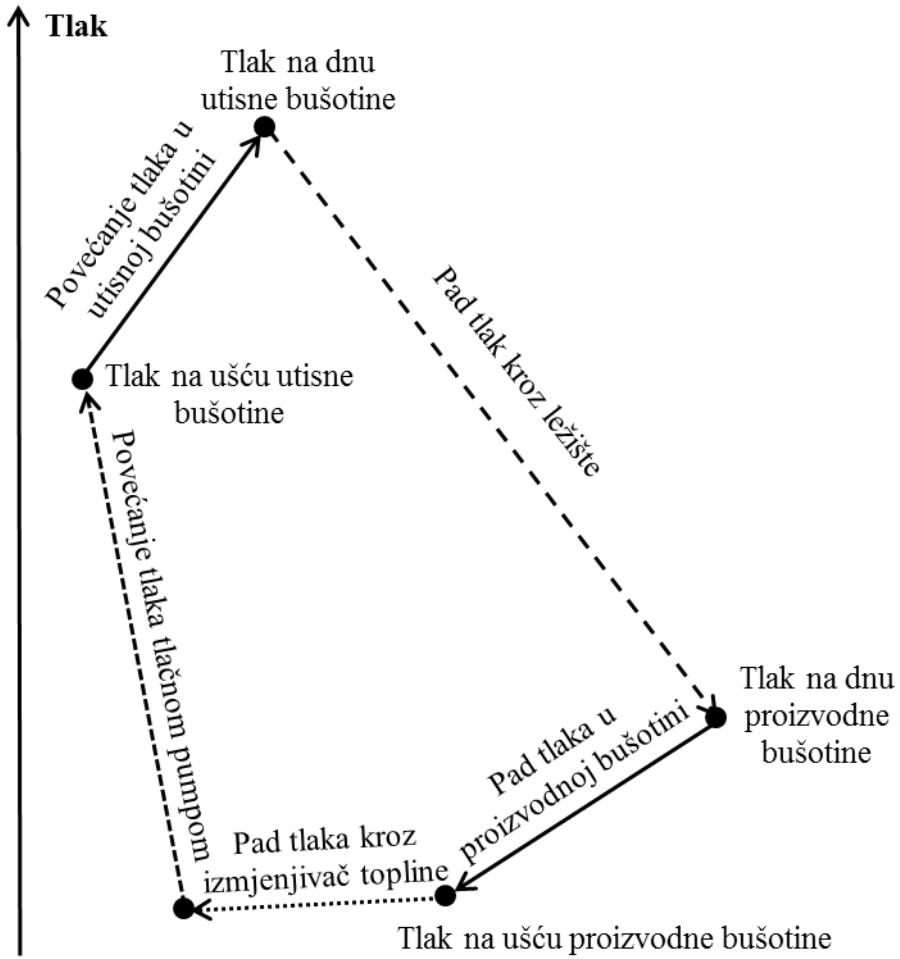
**Slika 4-8.** Shematski prikaz promjene tlaka kroz EGS sustav
