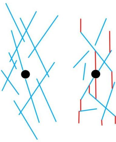
**Slika 4-3.** Shematski prikaz stimuliranja klizanjem (McClure i Horne, 2014)
