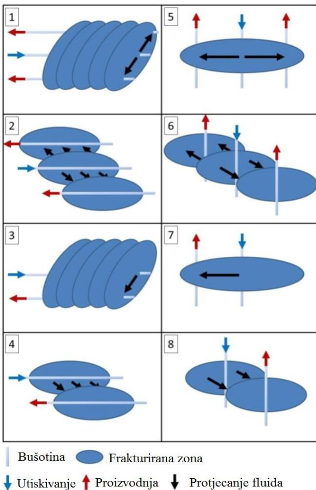
**Slika 4-2.** Pregled različito postavljenih bušotina i orijentiranih jednostrukih frakturna u frakturiranom EGS ležištu (Hofman, 2014)
