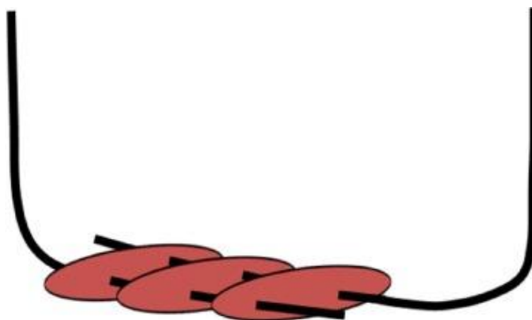
Slika 5-1. EGS koncept s horizontalnom utisnom i proizvodnom bušotinom međusobno povezanim s jednostrukim frakturama (Li i sur., 2014)
