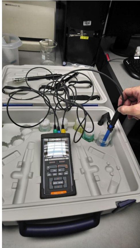
Slika 3-6 Uređaj za mjerenje elektrovodljivosti, pH, temperature te koncentracije kisika u ispitivanim uzorcima
