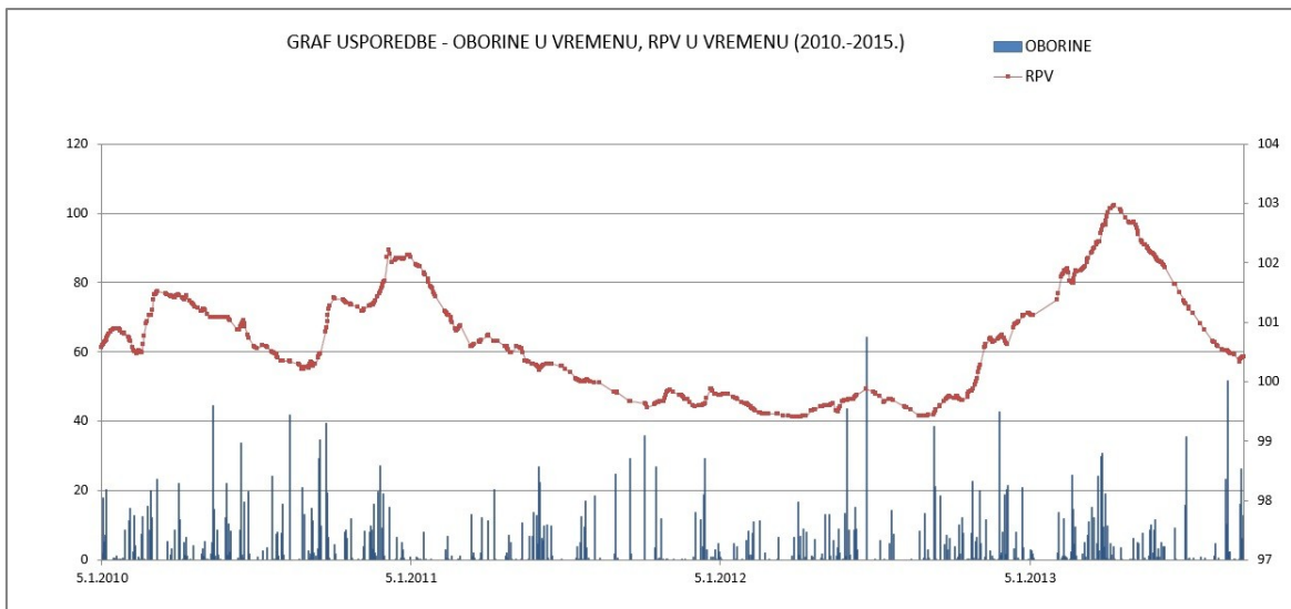
Slika 5-1. Pluviogram meteorološke postaje Kosnica u usporedbi s nivogramom piezometra PI-17 na vodocrpilištu Kosnica
