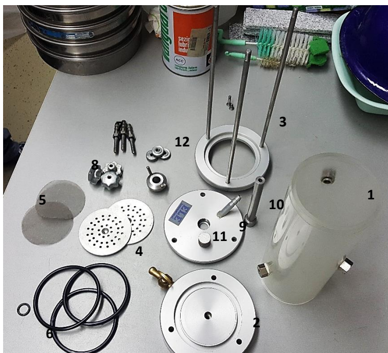
Slika 4.5 Dijelovi permeametra: (1) Čelija permeametra, (2) donja bazna ploča s ventilom, (3) tronožac za učvršćivanje, (4) porozni disk, (5) filtarske mrežice, (6) gumice, (7) manometarske spojnice, (8) gornji navoji, (9) gornja ploča s otvorom, (10) potisni klip, (11) odzračni ventil, (12) donji navoji.
