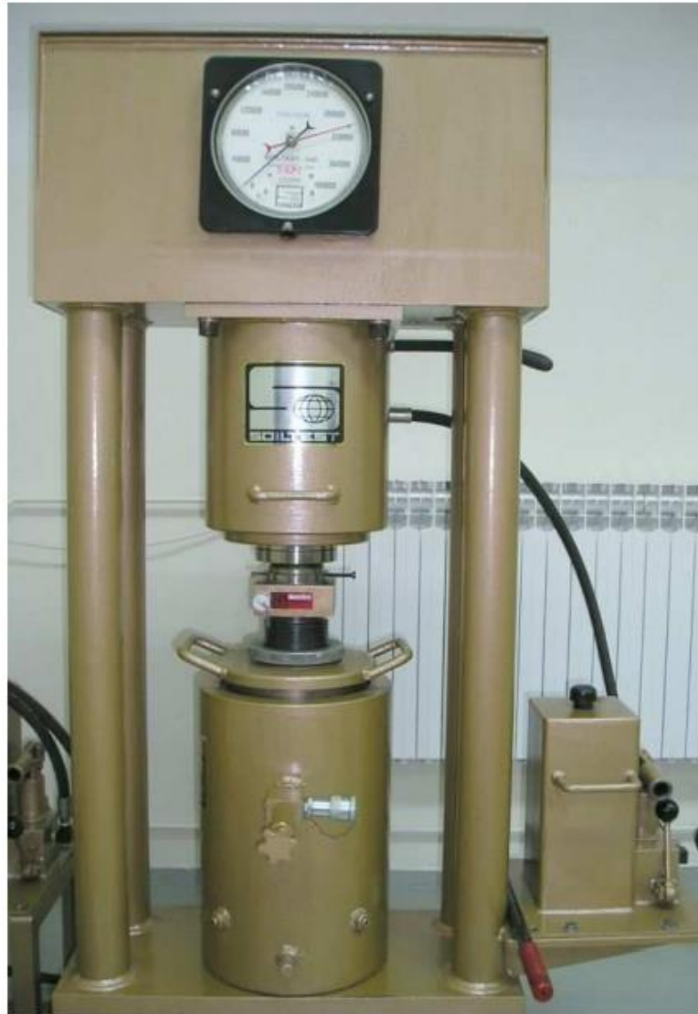
Slika 3-1. Preša SOILTEST CT-732.
