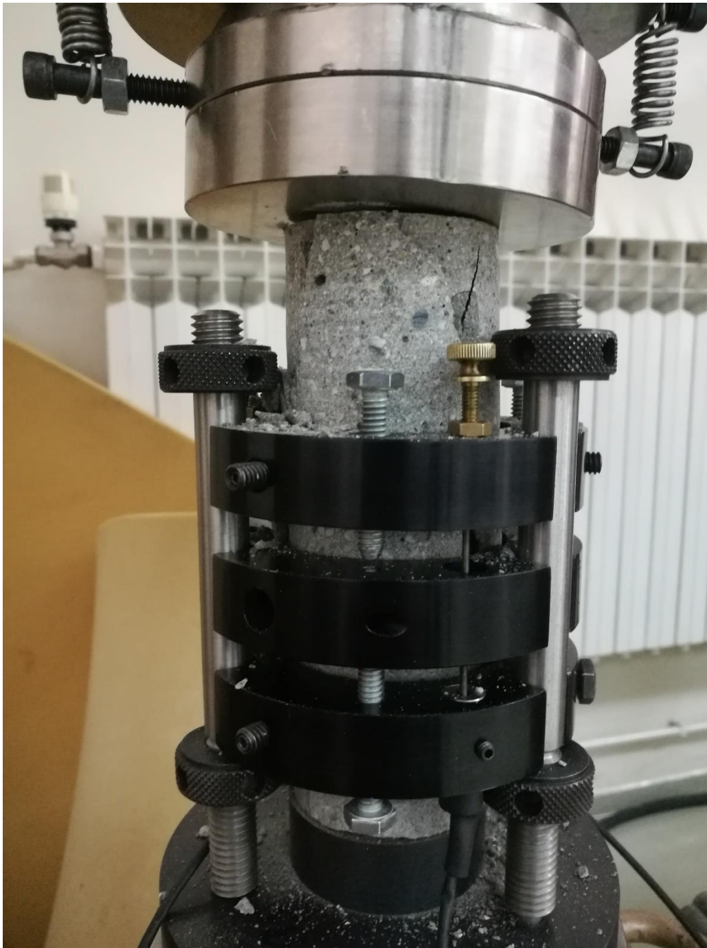
Slika 6-4. Prikaz uzorka nakon sloma
