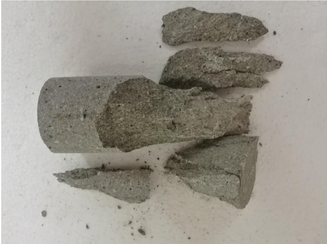
Slika 6-6. Prikaz uzorka 18-001-001 nakon sloma.
