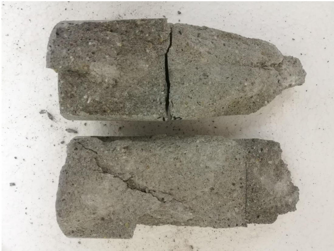
Slika 6-12. Prikaz uzorka 18-001-004 nakon sloma
