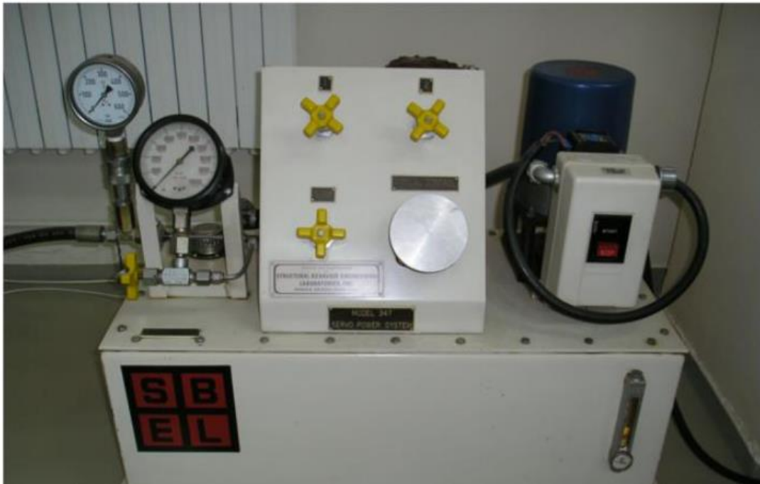
Slika 3-2. SBEL servo pumpa.
