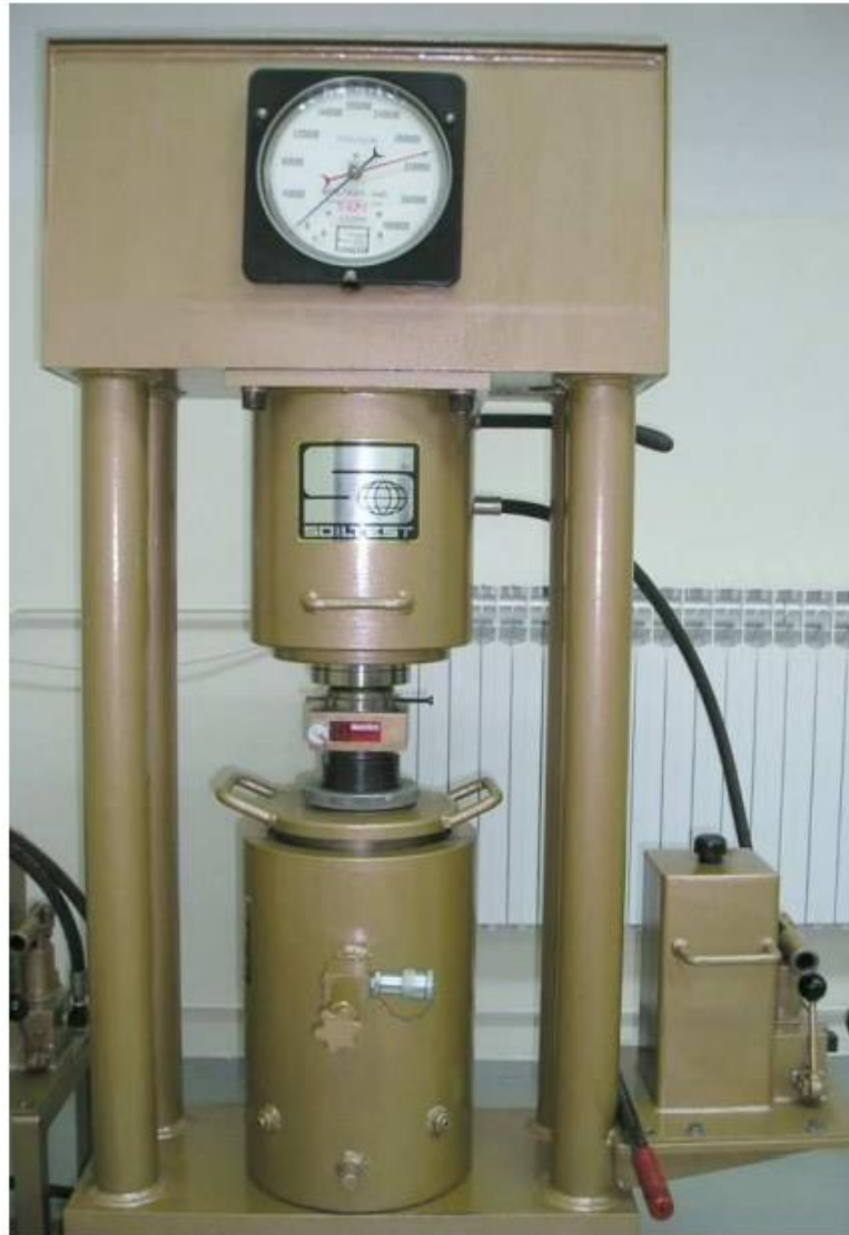
Slika 3-1. Preša SOILTEST CT-732.
