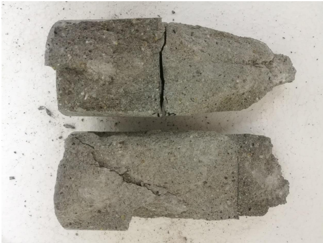
Slika 6-12. Prikaz uzorka 18-001-004 nakon sloma
