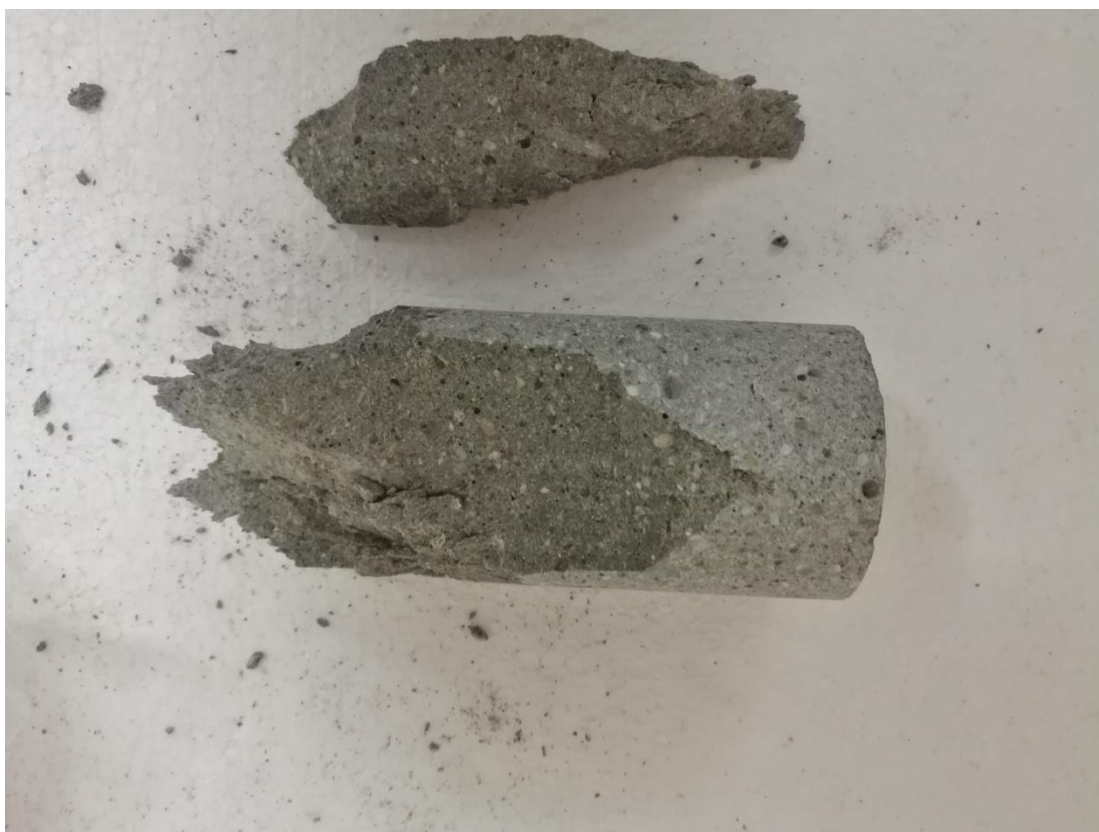
Slika 6-14. Prikaz uzorka 18-001-005 nakon sloma.
