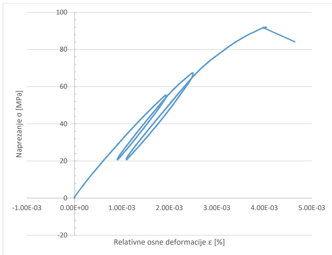
Slika 6-11. Dijagram naprezanja i deformacija za uzorak 18-001-004.
