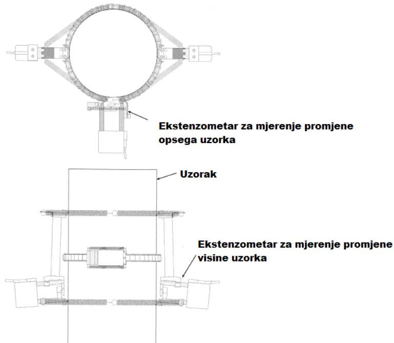
Slika 2-2. Sustav mjerjenje deformacija pomoću ekstenzometara (ISRM, 1979).
