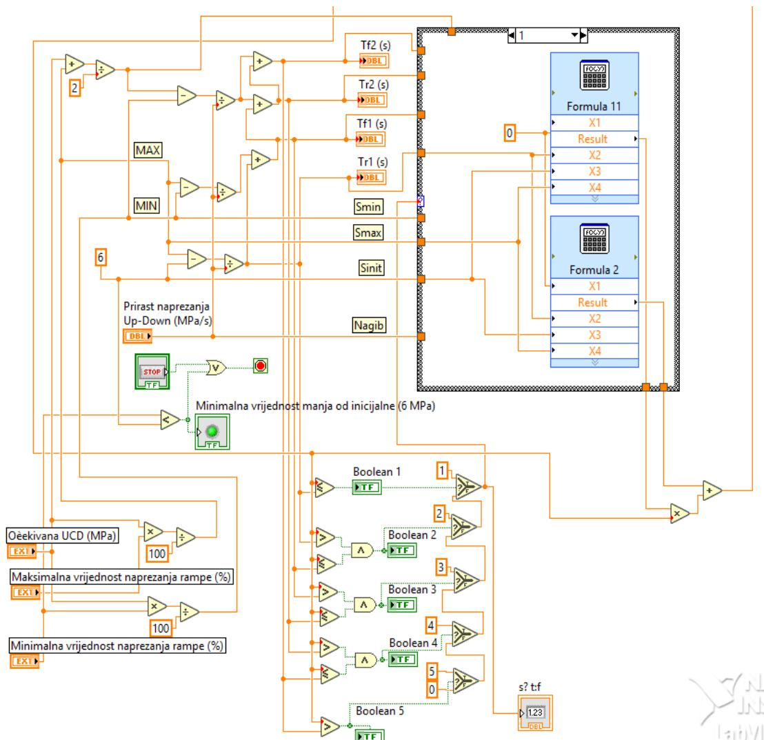
Slika 5-12. Konfiguracija za provedbu cikličkog opterećenja i rasterećenja.
