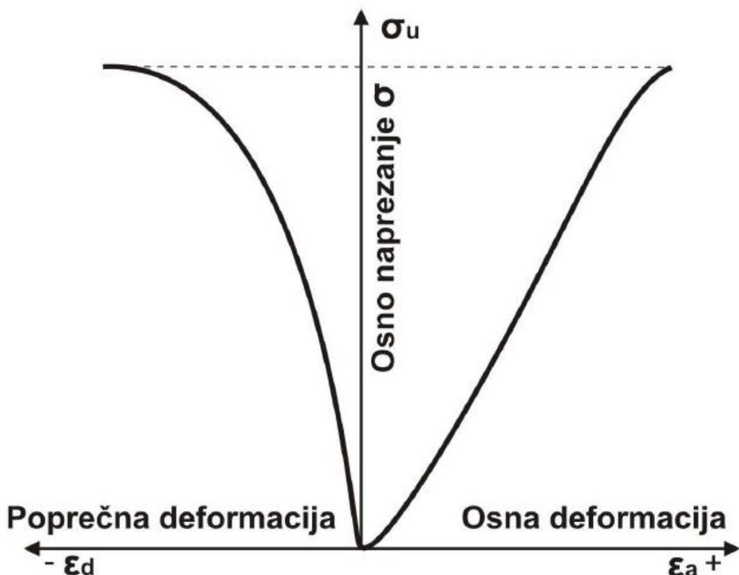
Slika 2-3. Dijagram naprezanja i deformacija (Hrženjak i Briševac, 2009.)
