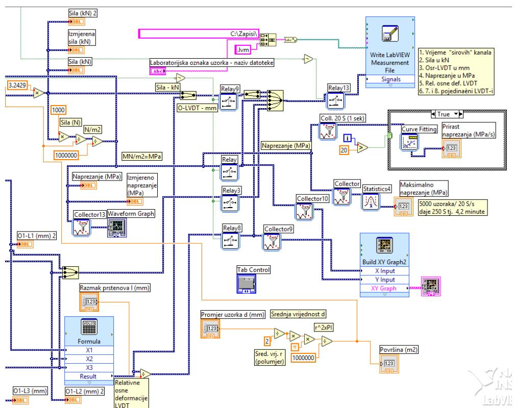
Slika 5-10. Obrada i zapis podatak mjerena
