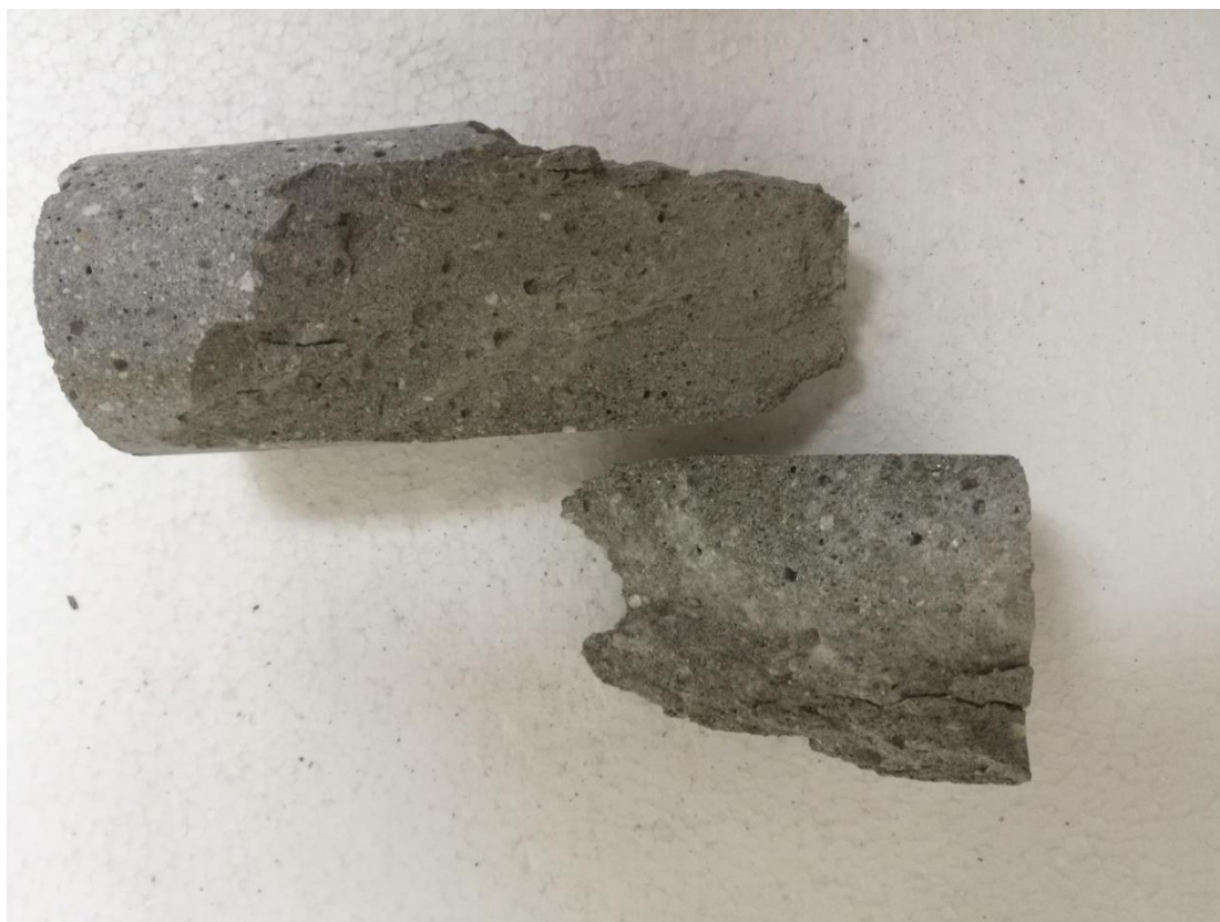
Slika 6-8. Prikaz uzorka 18-001-002 nakon sloma.
