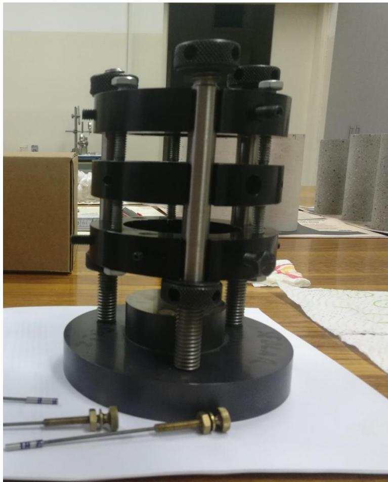
Slika 6-2. Sustav za mjerjenje osnih deformacija
