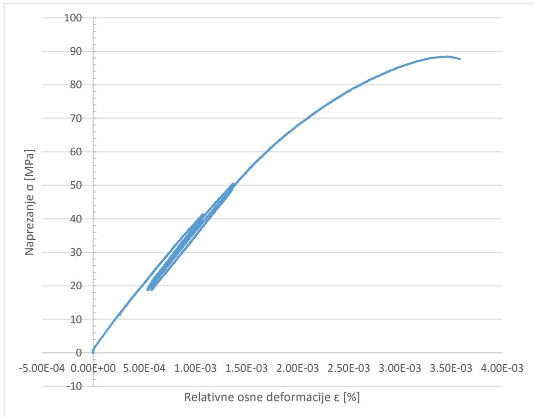
Slika 6-5. Dijagram naprezanja i deformacija za uzorak 18-001-001.
