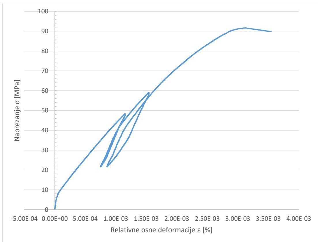
Slika 6-7. Dijagram naprezanja i deformacija za uzorak 18-001-002.
