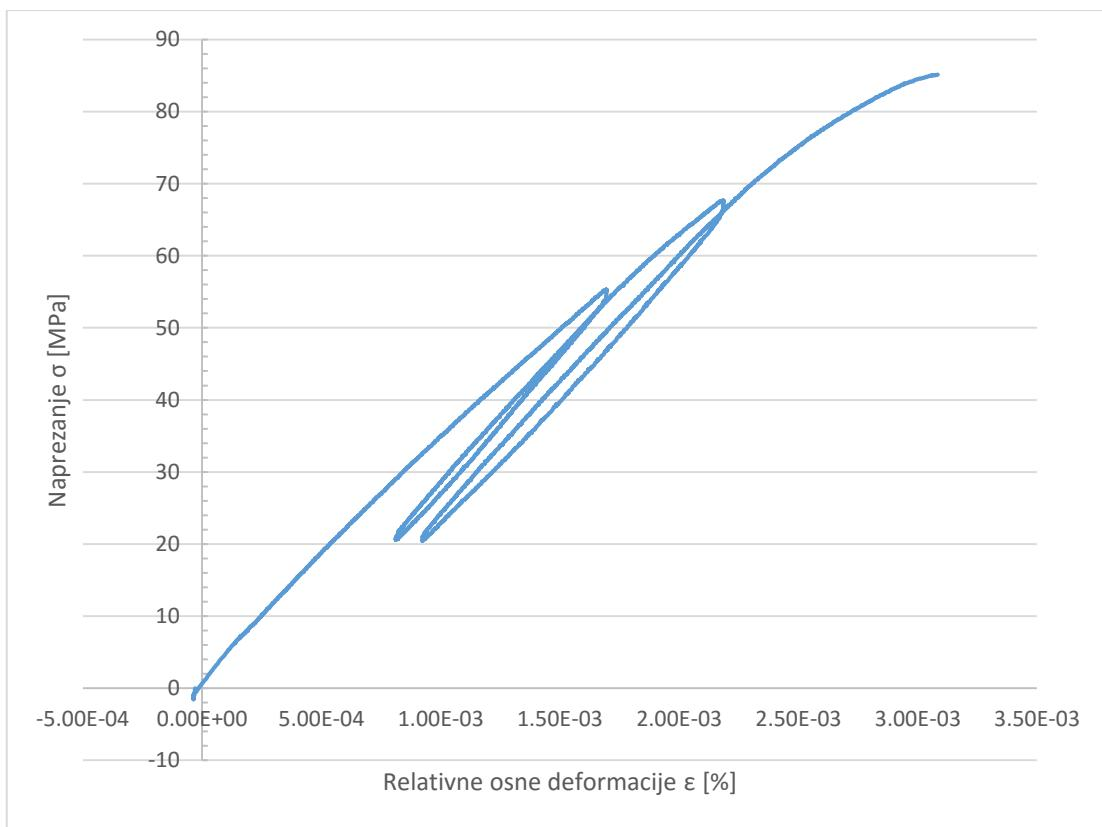
Slika 6-13. Dijagram naprezanja i deformacija za uzorak 18-001-005.
