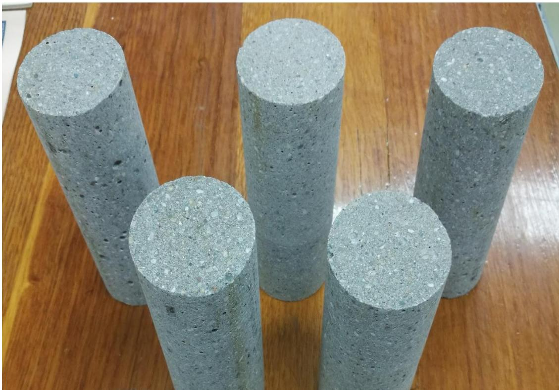
Slika 6-1. Uzorci za ispitivanje jednoosne tlačne čvrstoće.
