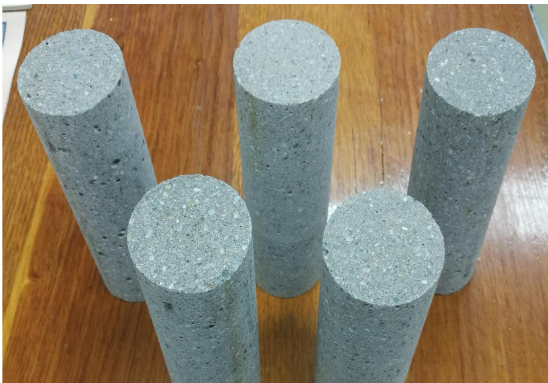
Slika 6-1. Uzorci za ispitivanje jednoosne tlačne čvrstoće.
