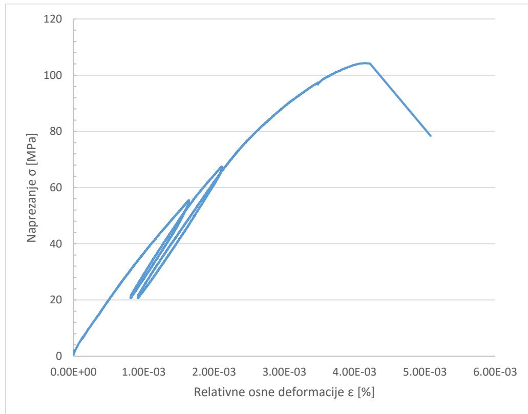
Slika 6-9. Dijagram naprezanja i deformacija za uzorak 18-001-003.
