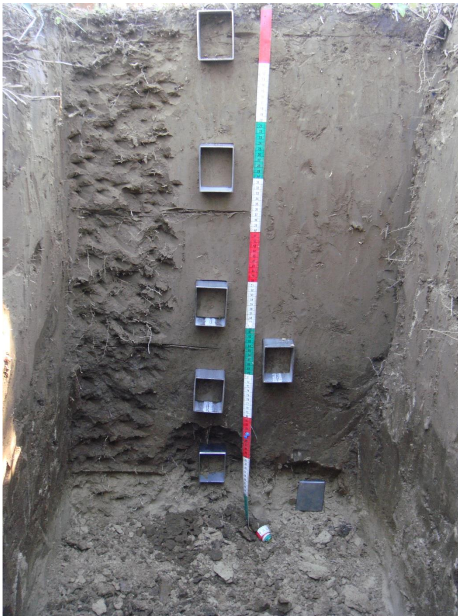
Slika 4.2. Pedološki profil “Svjetionik” i uzorkovanje Kubieninim kutijama
