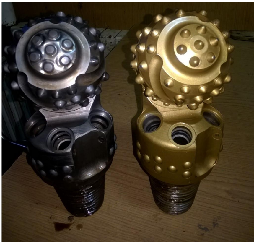
Slika 5-5. Jednožrvanjsko dlijeto promjera 95,25 mm (3 ¾") korišteno za bušenje otvorenog kanala (Lelak, 2017)
