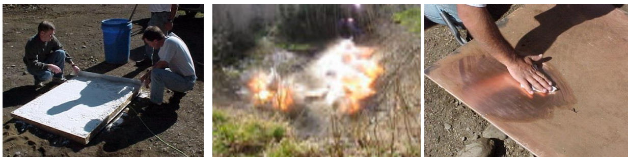
Slika 3-10. Priprema za zavarivanje, zavarivanje i gotov proizvod (High Energy Metals, 2009)
