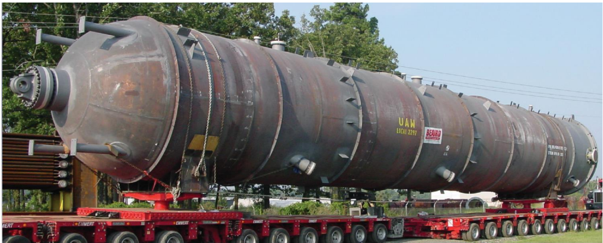
Slika 3-8. Cr-Mo čelik + nehrđajući čelik 321 (102 mm + 3 mm) 5m diam x35m (Nobelclad, 2016)
