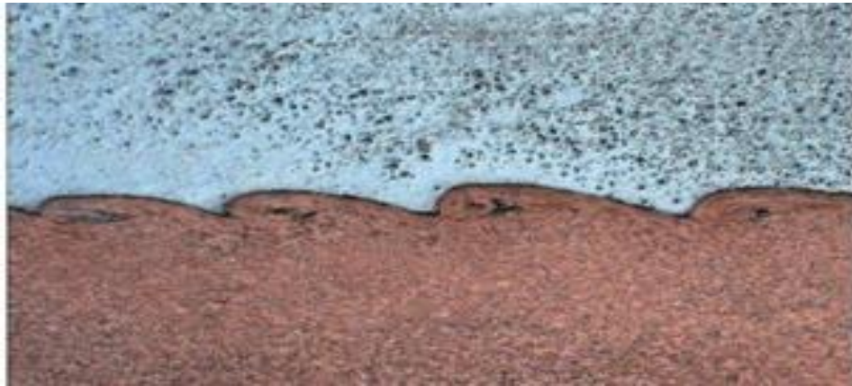
Slika 3-3. Oblik spoja nastao zavarivanjem
