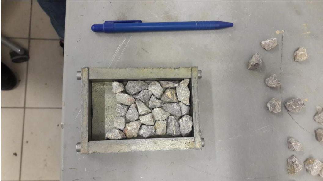
Slika 4-5 Postavljanje zrna agregata u kalupe
