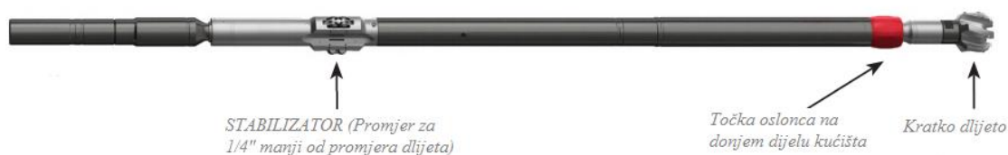
Slika 4-1. Rotirajući upravljivi sustav Dirigo tvrtke Halliburton (Halliburton, 2016)
