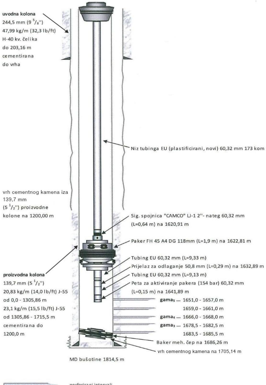
Slika 5-3. Shematski prikaz opreme u bušotini A prije dozagevljenja (INA d.d., 2013a)
