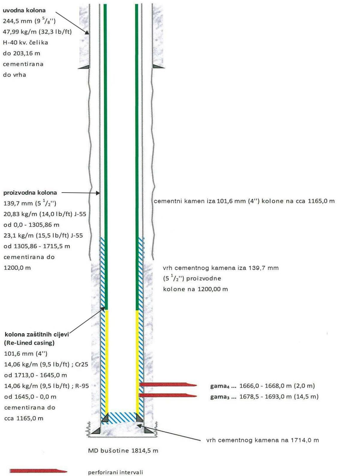
Slika 5-4. Shematski prikaz opreme u bušotini A nakon dozacevljenja (INA d.d., 2013a)
