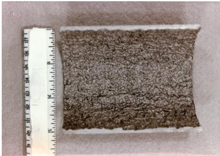
Slika 4-2. Rupičasta korozija (Pipeliner Indonesia, 2016)
