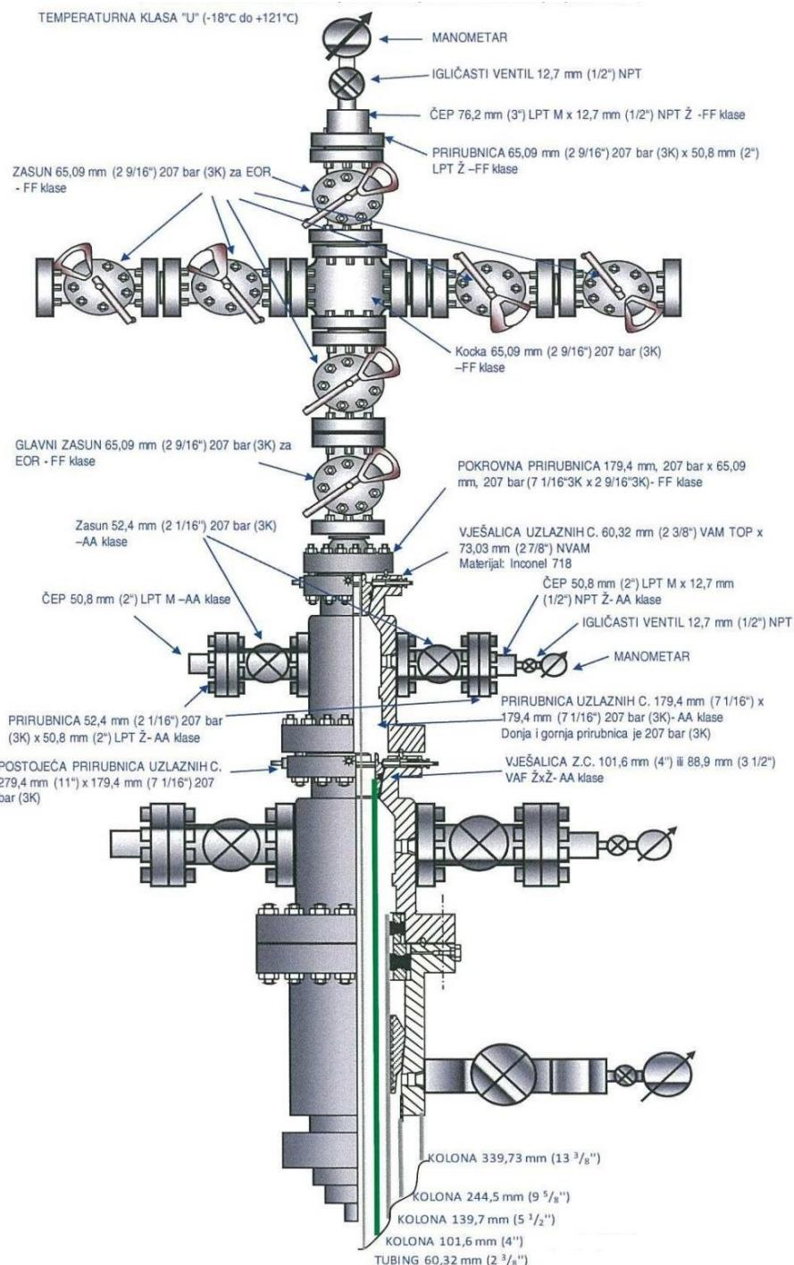
**Slika 5-7.** Stanje bušotinske glave i erupcijskog uređaja bušotine A nakon dozagevljenja (INA d.d., 2013a)
