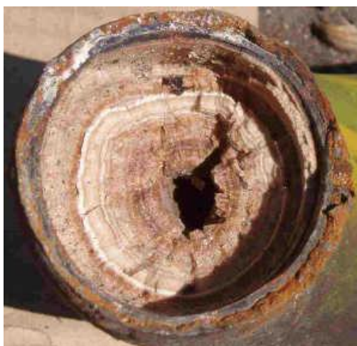
Slika 4-1. Kamenac unutar kolone zaštitnih cijevi (Voens, 2017)
