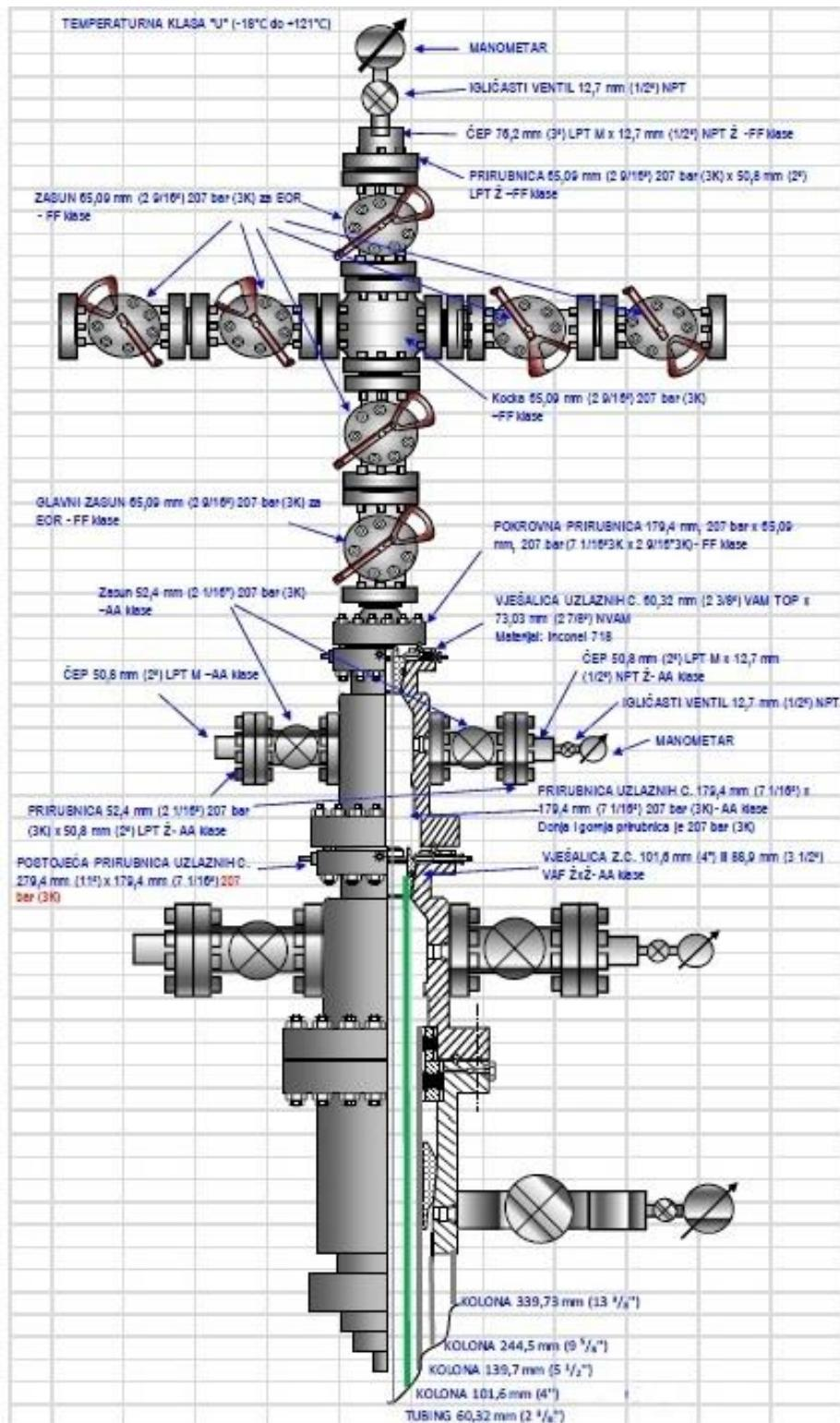
**Slika 5-12.** Prikaz bušotinske glave i erupcijskog uređaja bušotine B nakon dozagevljenja (INA d.d., 2013b)
