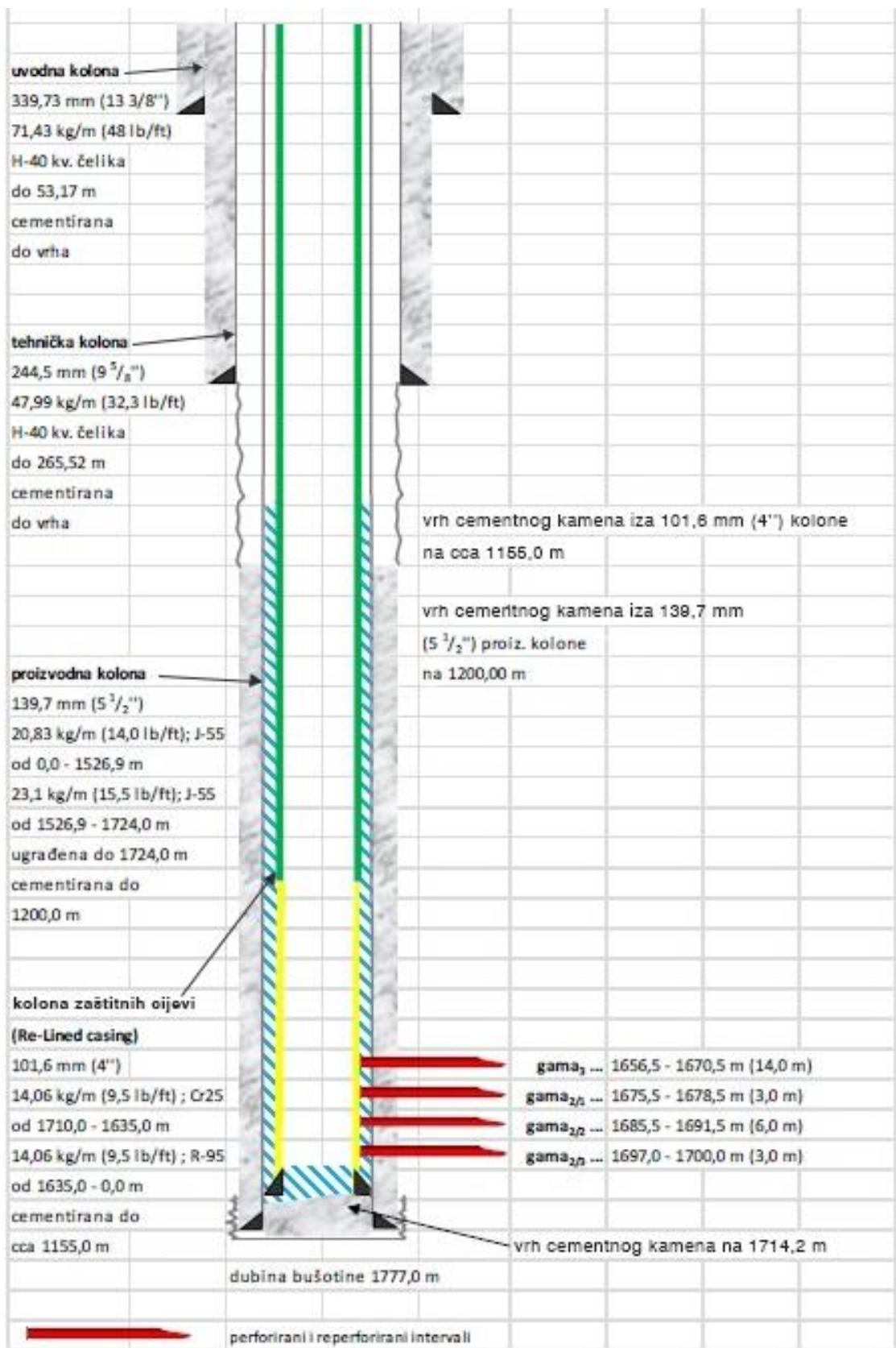
Slika 5-10. Shematski prikaz opreme u bušotini B nakon dozacevljenja (INA d.d., 2013b)
