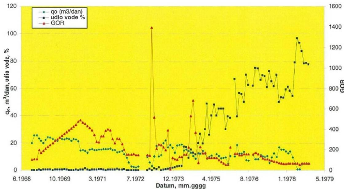
**Slika 5-1.** Povijest proizvodnje bušotine A (INA d.d., 2013a)
