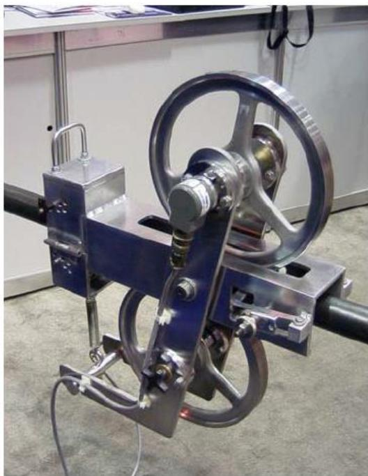
**Slika 3-7.** Dodatni mjerni uređaj duljine tubinga (CTES LP, 2005)
