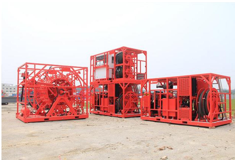
Slika 4-1. Postrojenje za rad sa savitljivim tubingom montirano na prijenosne konstrukcije (American Jereh, 2018)
