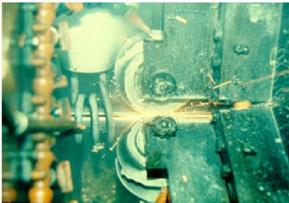
Slika 2-4. Indukcijsko varenje rubova trake u savitljivi tubing (CTES LP, 2005)
