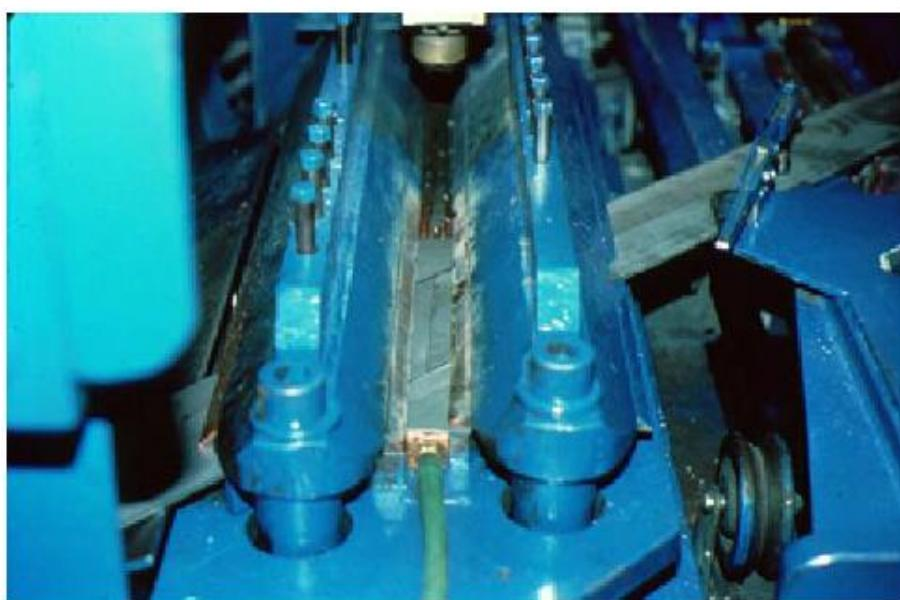
**Slika 2-3.** Izrada spiralnog varu (CTES LP, 2005)
