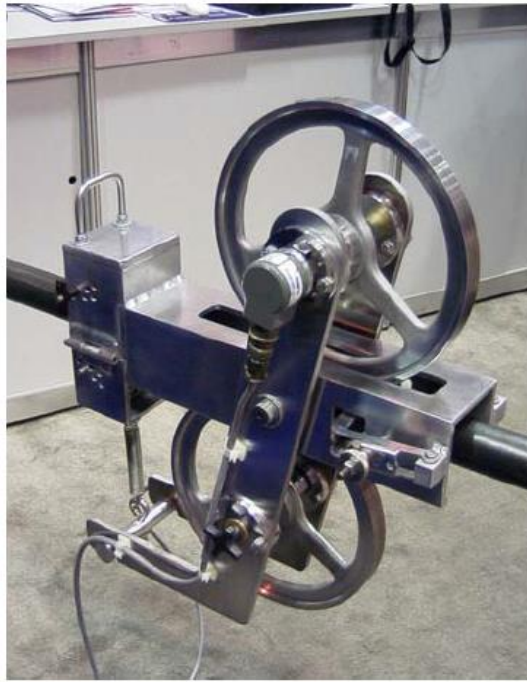
Slika 3-7. Dodatni mjerni uređaj duljine tubinga (CTES LP, 2005)
