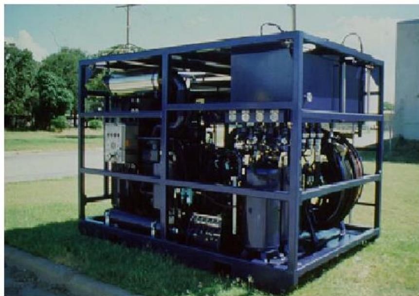
**Slika 3-2.** Pogonsko-hidraulički sklop na prenosivom postolju (CTES LP, 2005)
