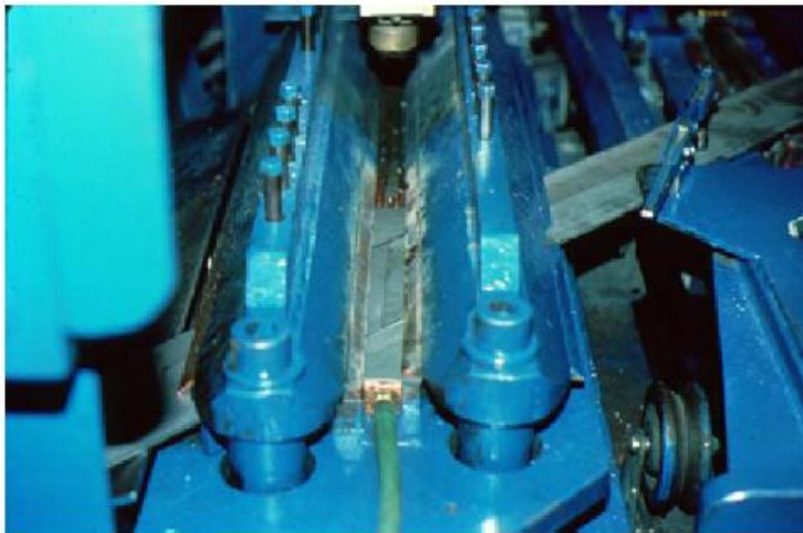
Slika 2-3. Izrada spiralnog vara (CTES LP, 2005)
