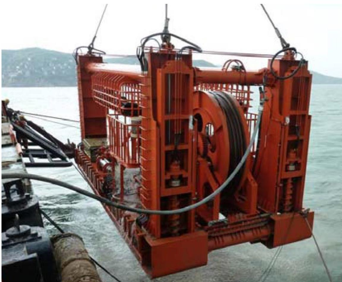
**Slika 4-6.** Platforma za podvodno horizontalno usmjereni bušenje (Wang i drugi, 2012)
