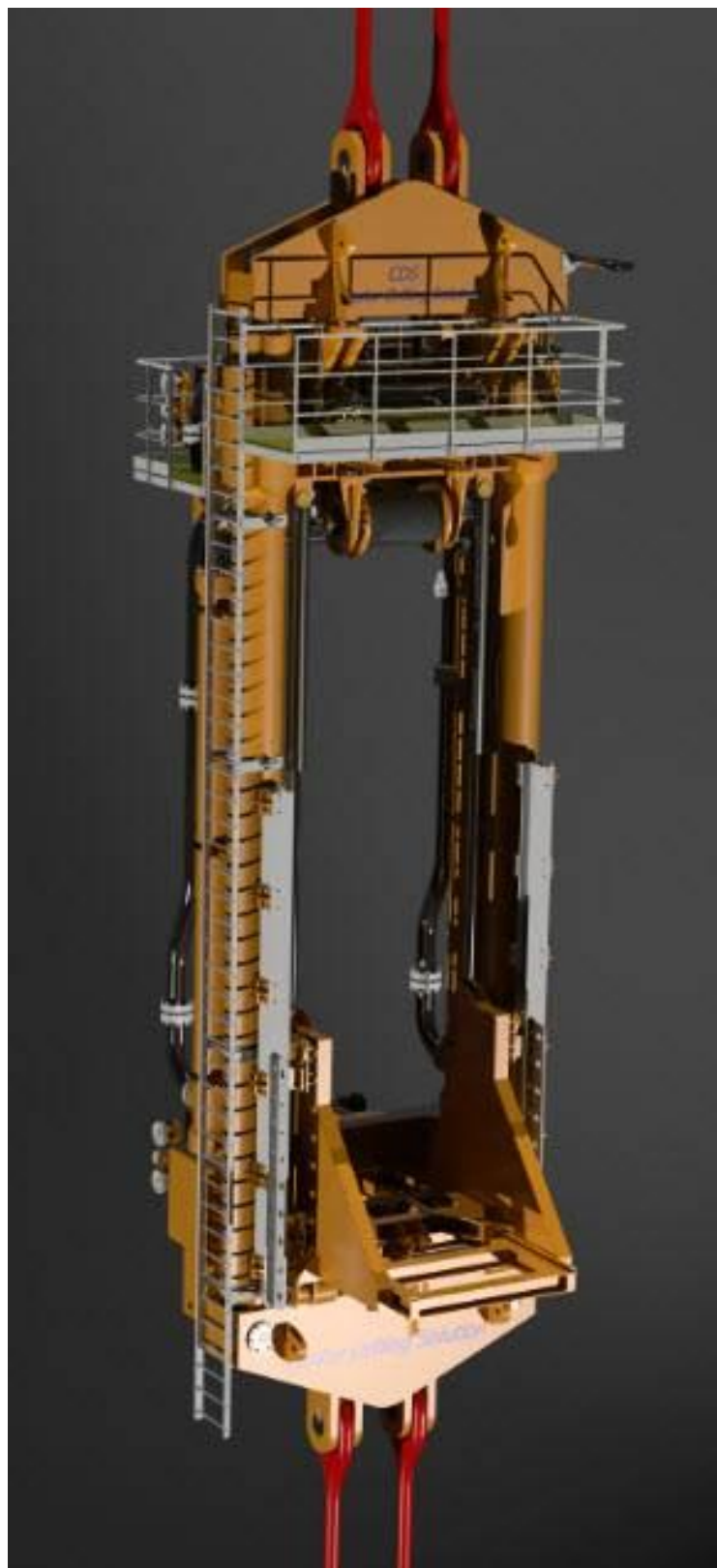
Slika 3-14. Podizúci okvir (CDS, 2018)
