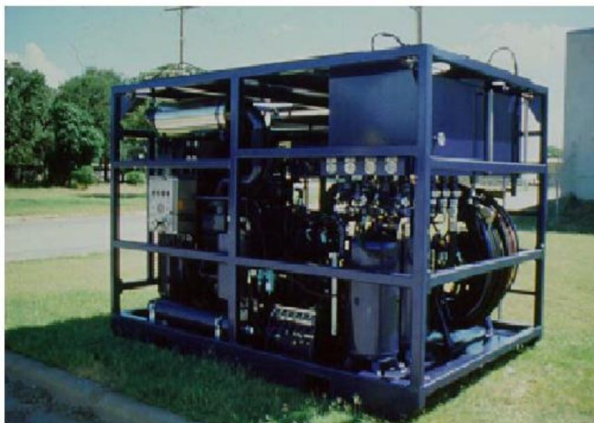
Slika 3-2. Pogonsko-hidraulički sklop na prenosivom postolju (CTES LP, 2005)
