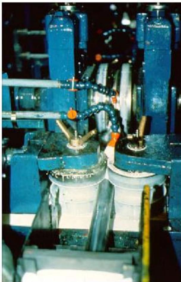
**Slika 2-5.** Smanjivanje promjera novonastalog tubinga (CTES LP, 2005)
